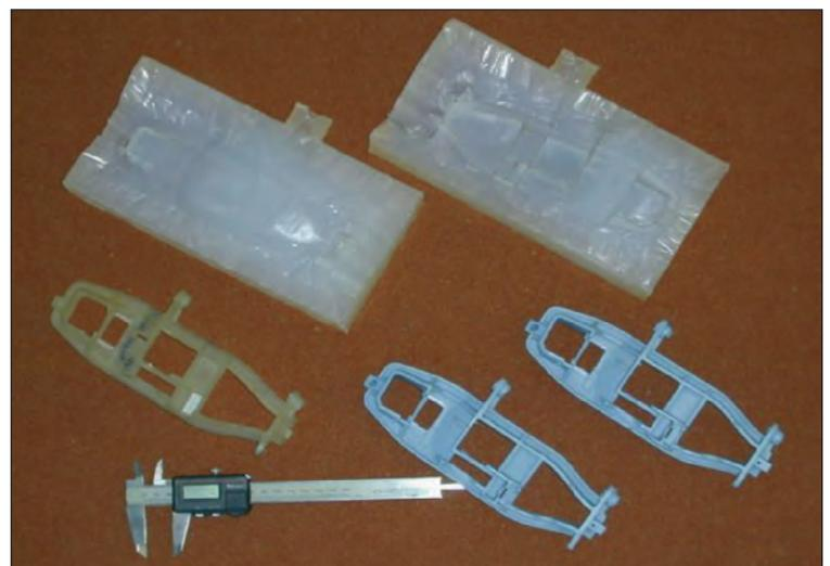
Bild 48 : Gussteile für Kfz-Türbeschlag (Prototypen für spätere Zink-Druckgussserien), Besonderheit: Druckguss-Werkstoff: Z 410 (ZnAl4Cu1), Urmodell: Stereolithographie, Wachsspritzform: 2-Komponenten-Silicon, Herstelldauer: 14 Arbeitstage, Stückzahl: 20 (Bild: Spacecast, Eschweiler)
