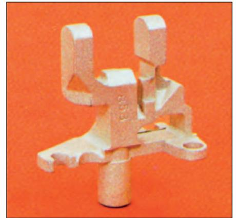
**Bild 69:** Führungsstück für den Fahrzeugbau aus G-CuZn35Al1 (W.-Nr. CC765S); Abmessungen. 90 x 60 x 40 mm, Gewicht: 250 g (unten rechts) (Alle Bilder: ZGV)
