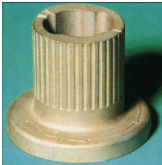
**Bild 82:** Rändelhülse für Elektrowerkzeug aus G16MnCr5 (W.-Nr. 1.7131), Abmessungen: Dmr. 46/29 x 35 mm, Gewicht: 123 g (Beide Bilder: ZGV)
