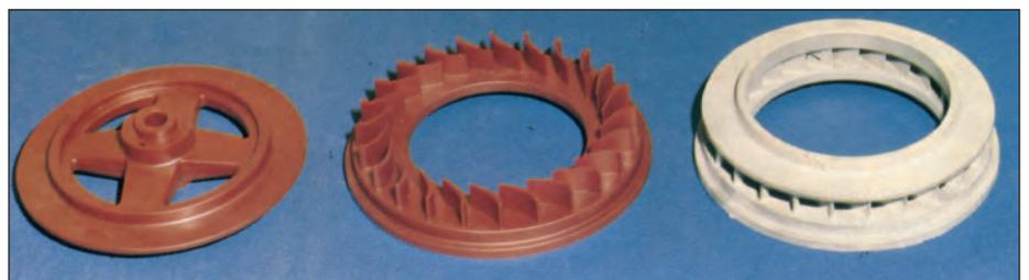
**Bild 87:** Zweiteiliges Ausschmelzmodell (links und Mitte) für einen Turbinenlaufring (rechts) aus einem hitzebeständigen hoch legierten Edelstahl, Abmessungen: Dmr. 230 x 58 mm, Gewicht: 3150 g (Bild: Buderus, Moers)
