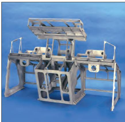
Bild 24: Instrumententräger für das Cockpit eines Verkehrsflugzeuges nach dem HERO Premium Casting gefertigt. Bei einer bedeutenden Gewichtsreduzierung ersetzt dieses Teil eine aus 296 Blech- und Frästeilen bestehende Fügekonstruktion (Bild: Tital, Bestwig)
