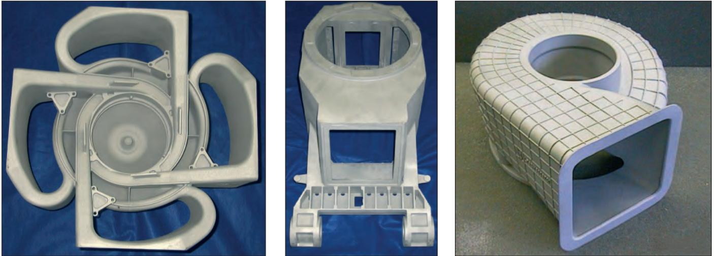
Bild 22: Strukturteile für Fluggeräte (a), für Optikträger (b) und für eine dünnwandige Verstärkung, alle nach dem Sophia-Verfahren gefertigt, Werkstoff: EN AC- $\text{AlSi7Mg0,6}$  (W.-Nr. EN AC-42200) (Bild: Zollern Soest)
