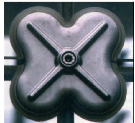
Bild 136: Lagergehäuse für Turbolader aus G25CrMo4 (W.-Nr. 1.7218) mit Keramik kern (weiß) gefertigt, Abmessungen: 125 x 200 mm, Gewicht: 4 200 g (links) (Bild: Zollern, Sigmaringen)
