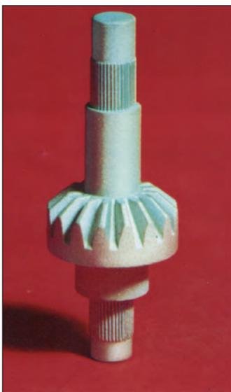
**Bild 81:** Baumaschinenteil mit vorgegossener Verzahnung und Rändelung, Werkstoff GX5CrNiMo-Nb18-10 (W.-Nr. 1.4581), Abmessungen: Dmr. 22 x Dmr. 9 x 59 mm, Gewicht: 44 g
