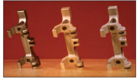
Bild 10: Mit demselben Modellwerkzeug aus Stahl, CuZn- und Al-Basis-Legierung jeweils entsprechend den Funktionsanforderungen hergestelltes Feingussteil für den allgemeinen Maschinenbau, Maße 140 x 75 x 55 mm (Bild: Feinguss Blank, Riedlingen)
