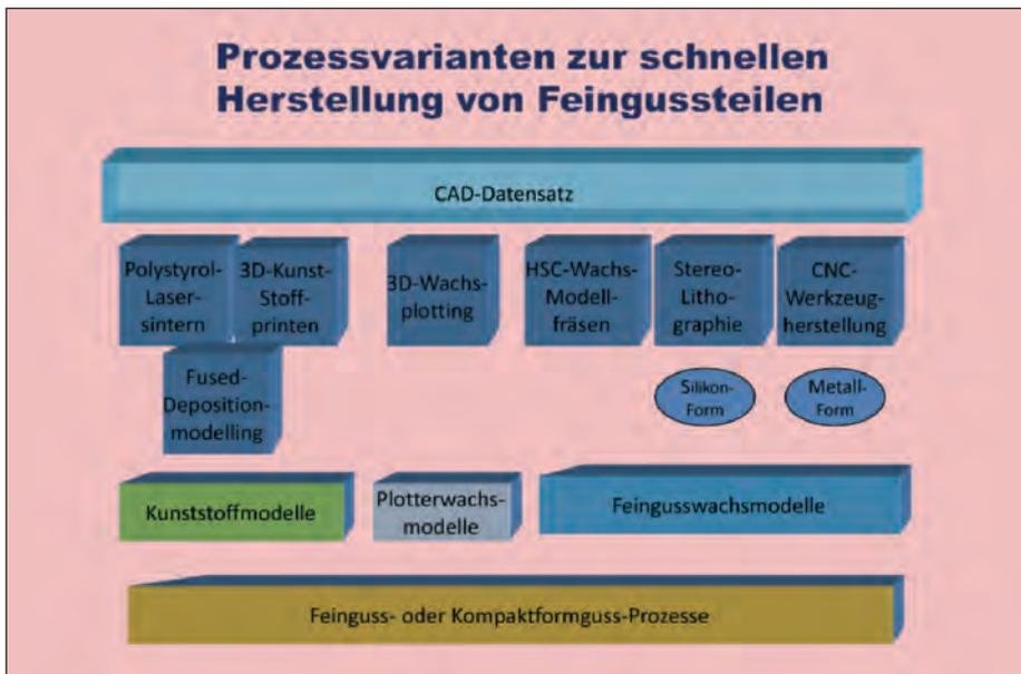
Bild 34: Die modell- und gusstechnischen Prozessketten zum schnellen Herstellen von Feingussteilen
