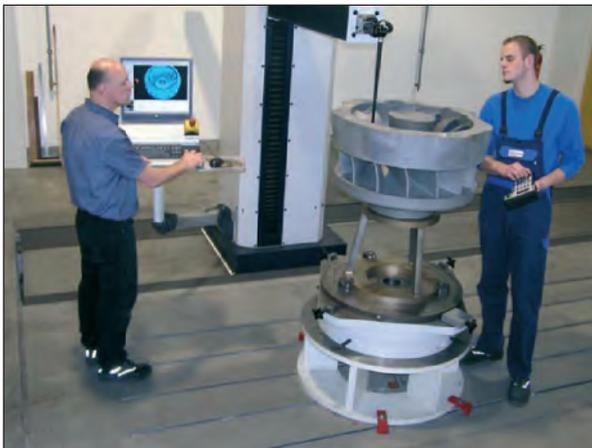
**Bild 29: Maßendkontrolle an einem Gussteil mit einer Messmaschine**
