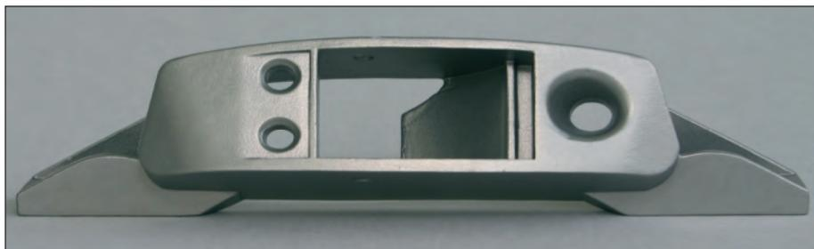
**Bild 54:** Verschlussplatte für den Fahrzeugbau aus Stahlfeinguss der Sorte GX5CrNi19-10 (W.-Nr. 1.4308), Größtmaß etwa 160 mm, Gewicht: 300 g (Bild: NRU, Neukirchen)
