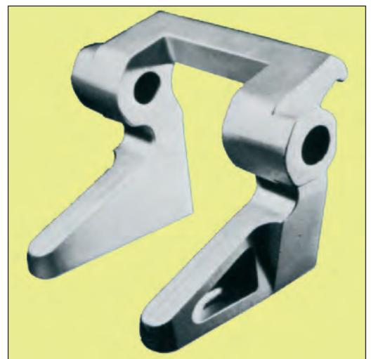
Bild 7: Feste Seilklemme für den Seilbahnbau, Werkstoff G25CrMo4 (W.-Nr. 1.7218), Abmessungen: 212 x 168 x 175 mm, Gewicht: 7,2 kg (Bei diesem Feingussteil wird eine Kostenersparnis von 28 % gegenüber dem früheren Schmiedeteil erzielt!) (Bild: ZGV)
