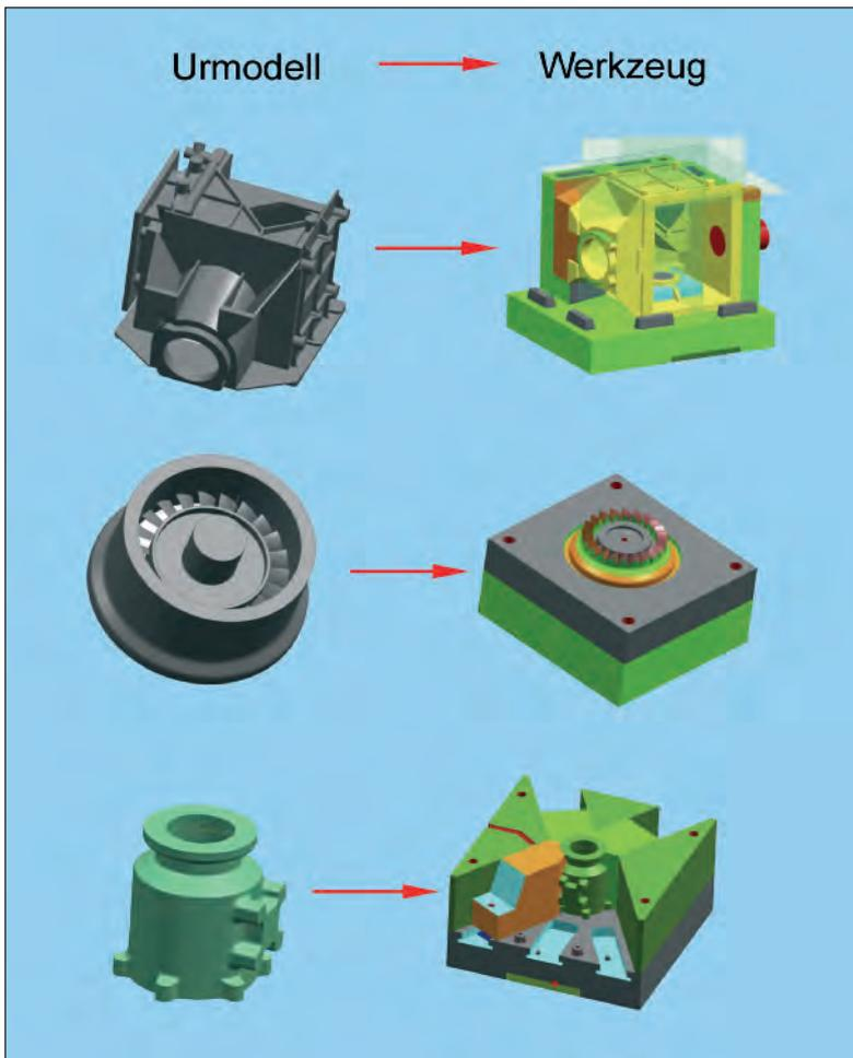
Bild 122: CAD-Datenmodell aus der Gussteilkonstruktion (links) und daraus abgeleitete Ausschmelzmodell-Werkzeugentwicklung in der Feingießerei mit Unigraphics NX 4
