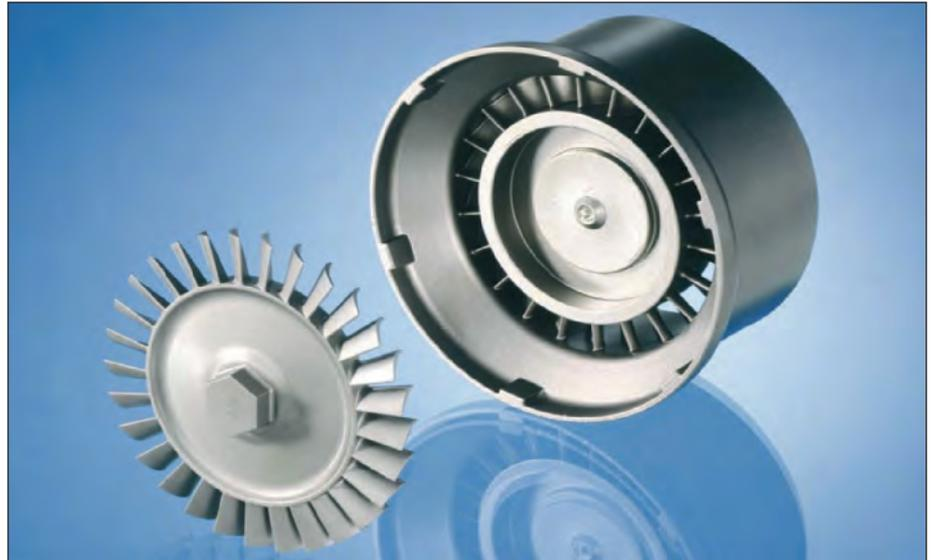
Bild 113: Modellturbinen für Modellflugzeuge (links) aus GNiCr13Al6MoNb, Gewicht: 220 g, die mit extrem dünnen Wanddicken im Feinguss gefertigt wurden (Bild: Zollern, Sigmaringen)
