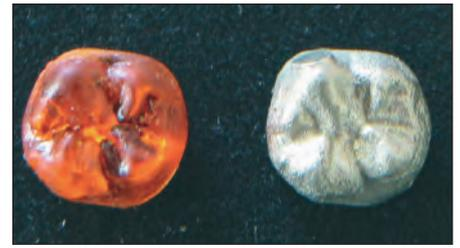
**Bild 50:** Einsatz von RP-Techniken in der Dentaltechnik zur Herstellung von individuell über 3D-Datenmodell gestalteten Kronen und Brücken aus speziellen körpervertäglichen Legierungen im Feingießverfahren (Bild: Envisiontec, Marl)
