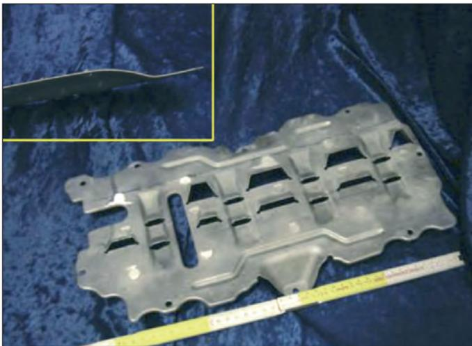
Bild 45: Ölleitblech, Maße: 470 x 210 mm, Wanddicke 0,8 mm, Gewicht: 0,15 kg, Werkstoff EN AC-Al-Si9Mgwa (W-Nr. EN AB-43300), Kompaktformguss, Stückzahl 2, Lieferzeit 8 Arbeitstage (Bild: Spacecast, Eschweiler)
