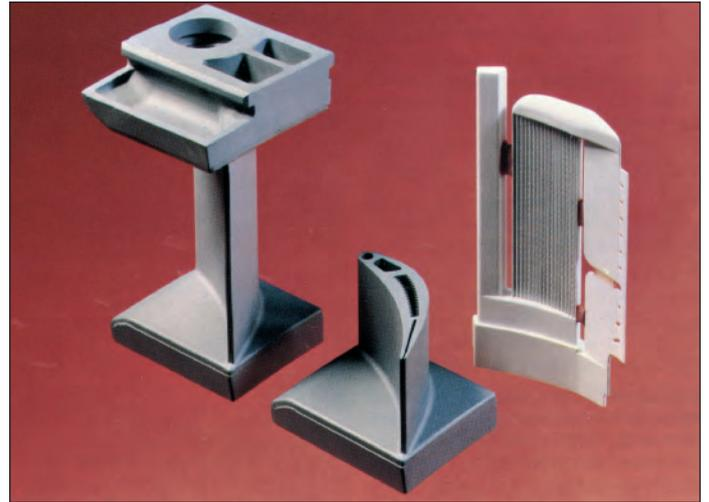
**Bild 85:** Gasturbinschaufel (links) aus einer warmfesten Nickel-Basislegierung und Schnitt durch dieses Teil (Mitte), dessen schmale Kühlkanäle durch keramische Kerne (rechts) abgeformt werden, Abmessungen: 205 x 115 x 110 mm, Gewicht: 4,1 kg (Bild: Doncasters)
