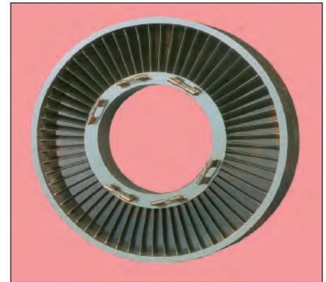
**Bild 62: Strator aus Titanfeinguss für Flugzeugturbine mit angegossenen Probestücken und 2 mm dicken Schaufeln, Werkstoff: GTiAl6V4 (W.-Nr. 3.7264), Dmr. 570 mm, Gewicht: 18 500 g (Bild: Tital, Bestwig) (oben)**
