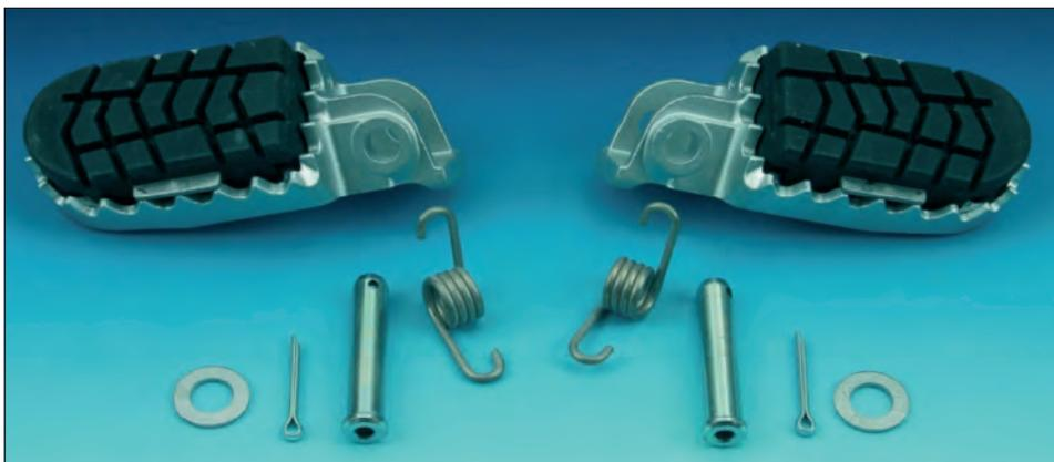
**Bild 49:** 200 g leichtes aber hoch belastbares Feingussteil Fußraste für Motor-Cross-Krafträder aus G42CrMo4 (W.-Nr. 1.7227), welches in der Gießerei nicht nur entwickelt und gefertigt, sondern auch montiert und paarweise samt Zubehör als Bausatz (rechts) direkt zur Montage zur Verfügung gestellt wird (Bild: Feinguss Blank, Riedlingen)
