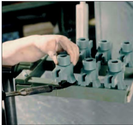
**Bild 19: Montage der vorgefertigten Ausschmelzmodelle an das Gießsystem zur Gießeinheit**
