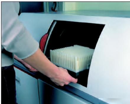
**Bild 42: Thermojet-Anlage zum schichtweisen Aufbau von Wachsmodellen für den Feinguss ohne Wachsspritzform (Bild: Feinguss Blank, Riedlingen)**
