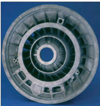
Bild 23: Gehäuse für das Zwischengetriebe einer Flugturbine, hergestellt nach dem HERO Premium Casting aus der Legierung EN AC- $\text{AlSi7Mg0,6}$ . Mit einem Gewicht von 80 kg gehört das Gussteil zu den größeren Feigussteilen. (Bild: Tital, Bestwig)
