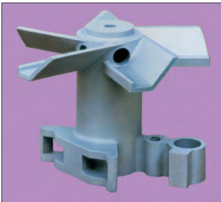
Bild 9: Feingegossener Zerstäuber für verbrennungstechnische Anlagen, Werkstoff EN AC-AlSi7Mg0,3 (W.-Nr. EN AC-42100), Abmessungen: Dmr. 84 x 62 mm, Gewicht: 82 g (Bild: Feinguss Blank, Riedlingen)
