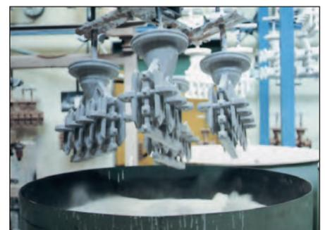
**Bild 21: Automatisierter Aufbau der Keramikschalenform durch abwechselndes Tauchen in Schlacker und fluidisiertem Sandbad**
