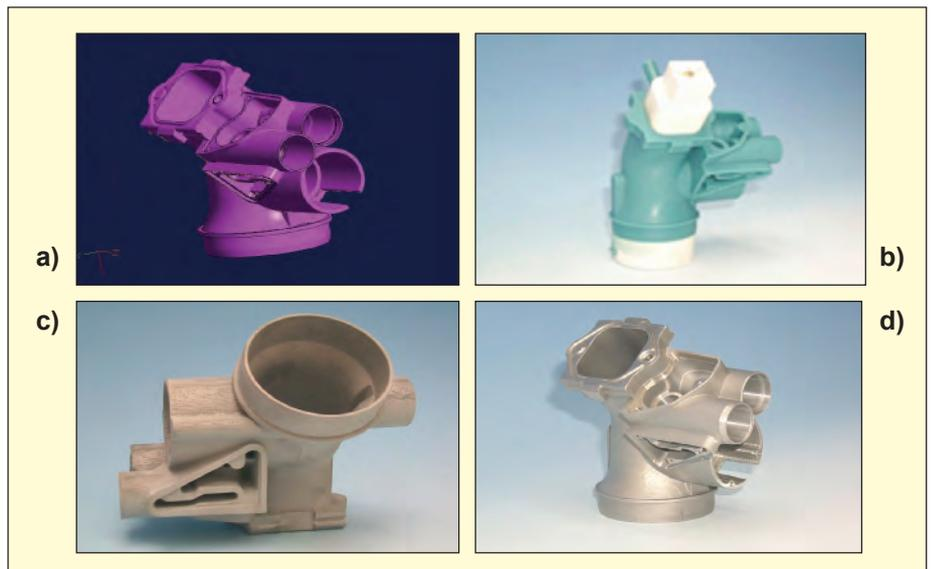
**Bild 121:** Prototypenfertigung nach dem Vakuum-Differenzdruck-Verfahren (VDD) mit durchgehender Nutzung der CAD-Daten am Beispiel des Feingussteils für einen elektronisch steuerbaren Saugregelmodul für Schraubenkompressoren (Bild: 1zu1 Prototypen, Dornbirm)
