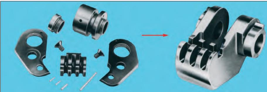
Bild 90: Bandklammerwerkzeug für eine Verpackungsmaschine, Werkstoff G15CrNi6 (W.-Nr. 1.5919), Abmessungen: 35 x 47 x 68 mm, Gewicht: 300 g (Einteilig feingegossen (rechts) sind die Herstellkosten gegenüber früherer Fügekonstruktion (links) um 72 % niedriger!) (Bild: ZGV)
