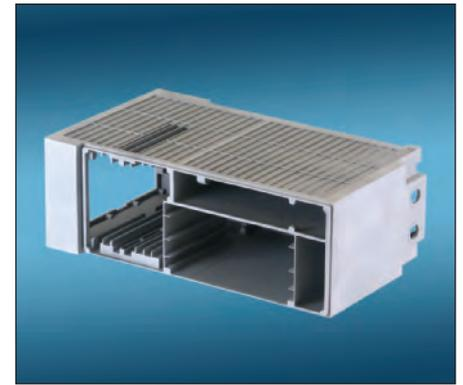
Bild 94: Elektronikgehäuse aus dem Werkstoff EN AC-AISi7Mg0,3 wa (W.-Nr. EN AC-42100) mit Außen- und Innenverrippung für Leiterplattenführungen, Maße 330 x 280 x 240 mm, Gewicht 5400 g (Bild: Zollern, Soest)
