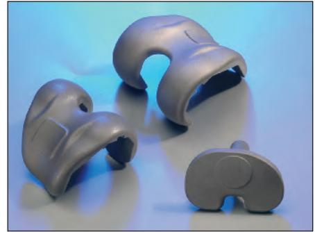
**Bild 56:** Feingussrohlinge Implantate für die Medizintechnik aus einer CoCrMo-Legierung gemäß ASTM F75 (Bild: Buderus, Moers)
