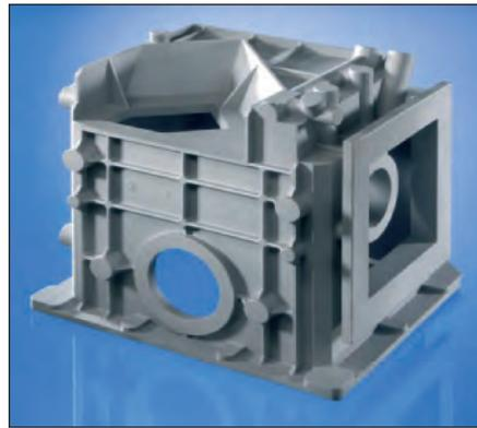
Bild 134: Eckblock für Laserstrahlumlenkung aus EN AC-AISi7Mg0,6 (W.-Nr. EN AC-42200), Abmessungen: 260 x 280 x 230 mm, Gewicht: 3600 g (Bild: Zollern Sigmaringen)
