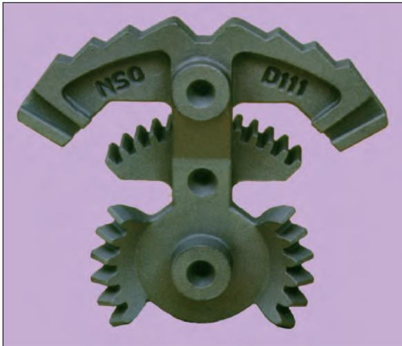
Bild 75: Rastenzahnsegment mit fertig gegossenen Zähnen für den Steuerungsteil einer Baumaschine, Werkstoff: GX5CrNiMoNb18-10 (W.-Nr. 1.4581), Abmessungen: 60 x 60 x 18 mm, Gewicht: 93 g (Bild: Feinguss Blank, Riedlingen)
