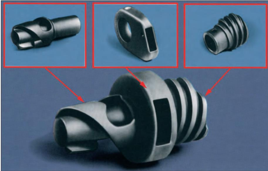
**Bild 79:** Verschluss für PKW-Schiebedach, für die Vorserie einteilig aus Vergütungsstahl feingegossen, Abmessungen: Dmr. 29 x 50 mm, Gewicht: 90 g (Bild: Buderus, Moers)
