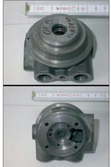
Bild 46: Lagergehäuse für einen Turbolader, Stückzahl 10, Abmessungen: 86 x 78 x 80 mm, Gewicht 700 g, Werkstoff EN-GJL-250, SLS-Polystyrol-Ausschmelzmodelle, hergestellt im Kompaktformverfahren. Besonderheit: Komplexe Gussteilinnenkontur mit Kerndurchmessern von 5 mm. Lieferzeit einschließlich Fertigbearbeitung 15 Arbeitstage (Bild: ES-Innocast, Langenfeld)
