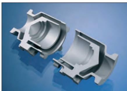
**Bild 53:** Wärmeabnehmer für Klimaanlage in Flugzeugen aus GNiCr19NbMoTi, Abmessungen: 80 x 86 x 84 mm, Gewicht: 980 g (Bild: Zollern, Sigmaringen)
