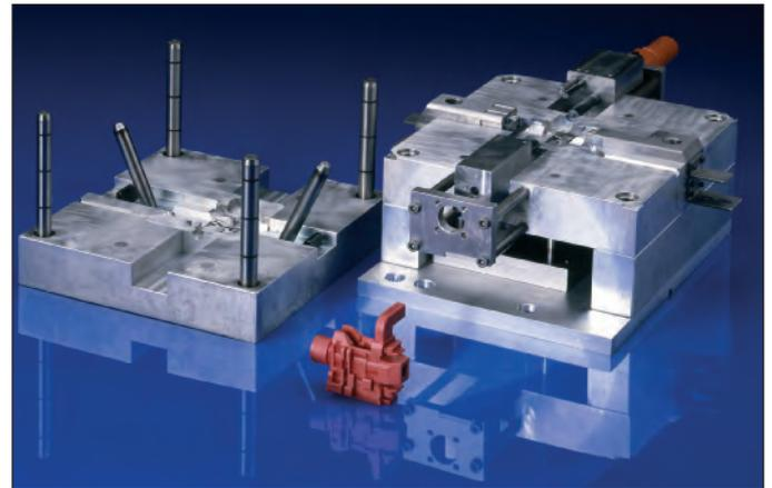
**Bild 16b:** Automatische Wachspritzzugform in Aluminiumausführung mit vier Stahlschiebern und Auswerfersystem
