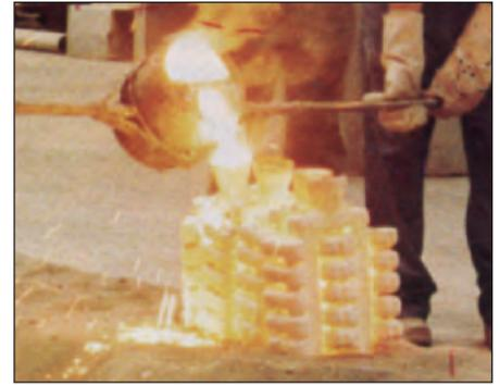
Bild 14: Brennen (a) und Abgießen (b) einer Feingießform
