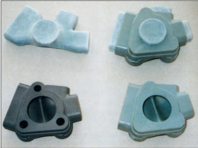
**Bild 84:** Feingussteil (unten links), dessen Innenraum am Wachsmodell (unten rechts) durch einen wasserlöslichen Kern (hellgrün) abgeformt wird (oben) (Bild: Schubert & Salzer, Lobenstein)
