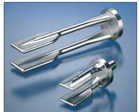
Bild 127: Einteilig gegossene Schwinggabeln für Füllstandsmessung aus dem Werkstoff GX-2CrNiMo18-14-3 (W.-Nr. 1.3952), Abmessungen: 106 x 38 mm, Gewicht: 78 g (oben) und 23 x 64 mm, 35 g (unten) (Bild: Zollern, Sigmaringen)
