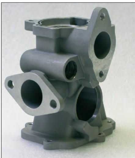
**Bild 35:** Gehäuse für den Fahrzeugbau nach dem Quick-Cast-Verfahren gefertigt aus der Aluminiumlegierung EN AC-AISi7Mg0,3 (W.-Nr. EN AC-42100), Gewicht 690 g, Größtmaß etwa 150 mm (Bild: NRU, Neukirchen)
