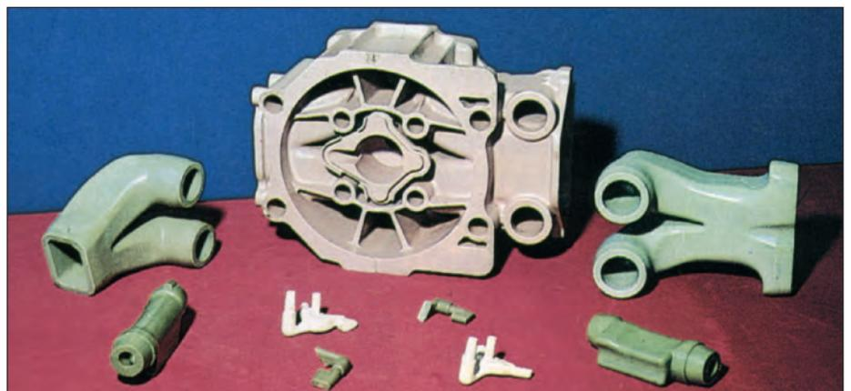
**Bild 86:** Zylinderkopf für einen Dieselmotor aus CrMo-legiertem Vergütungsstahlguss (Mitte), dessen Ausschmelzmodell mit Hilfe von wasserlöslichen (grün) und keramischen (weiß) Kernen hergestellt wurde. (Bild: ZGV)
