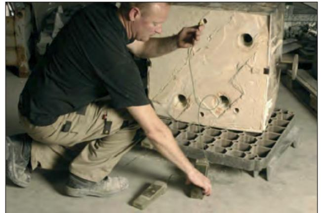
**Bild 37:** Herstellung von Gussteilen nach dem Kompaktformverfahren, hier Form aus gipsgebundenem Formstoff (auch bezeichnet mit „Gipsfeinguss“, Gipsguss, usw.) (Bild: Space-cast, Eschweiler)
