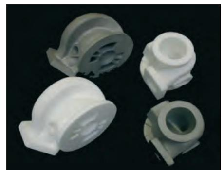
**Bild 39:** Projekt Druckwellenlader (Bild: ES-Innocast, Langenfeld), Bedarf je zwei Stück, Abmessungen: 150 x 150 x 145 mm mit komplexer Gussteil-Innengeometrie, Gewicht: 3 bis 4,5 kg, Werkstoff: GX40CrNiSi25-20 (W-Nr. 1.4848), Leistungsumfang: Erstellung Polystyrol-Ausschmelzmodelle, Abguss im Kompaktformverfahren, 3D-Messprotokoll, mechanische Endbearbeitung, Durchlaufzeit: 15 Arbeitstage (10 Arbeitstage ohne mechanische Bearbeitung) (rechts)
