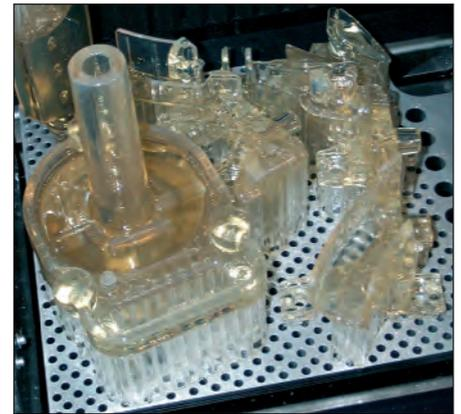
**Bild 20: Werkzeuglos mit dem generativen Verfahren Stereolithographie aufgebaute Ausschmelzmodelle (Quick-Cast-Verfahren)**
