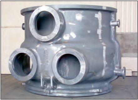
Bild 215: Gasturbinen-Verdichtergehäuse, Oberteil, Außenansicht aus EN-GJS-400-15-U, Gewicht 18,9 t, Abmessungen 3,8 x 2,6 x 1,7 mm (Bild: Römheld & Moelle, Mainz)
