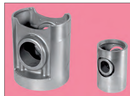
Bild 76: Kolben für Schiffsdiesel, Notstromaggregate und Lokomotiven aus EN-GJS-700-2 im Nennweitenbereich von 160 bis 640 mm und Gewichten von 15 bis 500 kg (Bild: Silbitz Guss)
