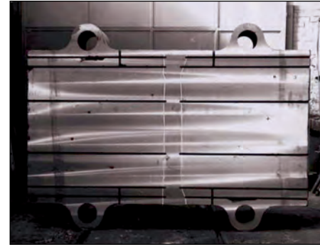
Bild 113: Maschinenbett aus EN-GJS-400-15, Gewicht 4 t (Bild: C. Hahn, Remscheid) links: In zwei Hälften zerbrochenes Teil rechts: mit arteigenem Schweißgut wieder instandgesetztes Teil
