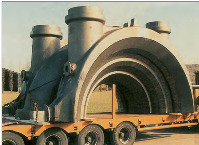
Bild 21: Dampfturbinen-Innengehäuse-Unterteil aus EN-GJS-400-15 für die Niederdruckstufe, Gewicht 43 t (Bild: ZGV, Düsseldorf)
