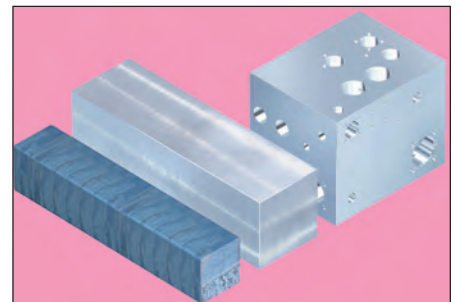
Bild 133: Strangguss kommt wegen seiner hohen Dichtheit bei Hydraulikgussteilen zum Einsatz (von links nach rechts: gegossene Stange im Rohzustand, vorbehandeltes und geböhrt Bauteil) (Bild: Gontermann-Peipers, Siegen)
