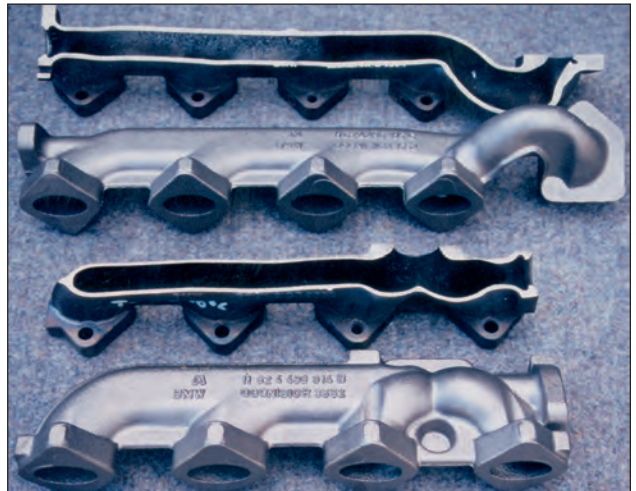
Bild 205: Dünnwandiger Abgaskrümmer für 8-Zylinder-Otto- und Dieselmotoren aus EN-GJSA-XNiSiCr35-5-2 (Bild: Montforts, Mönchengladbach)
