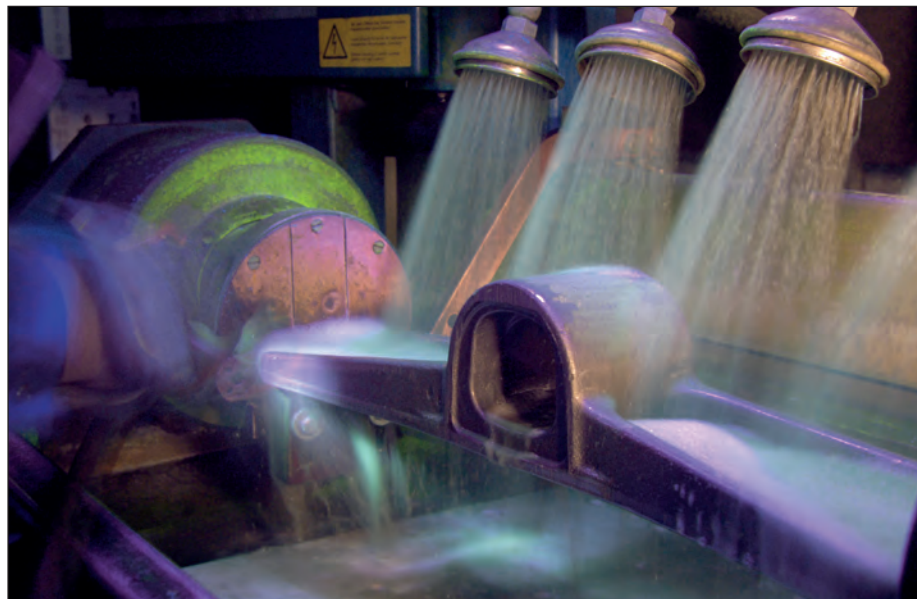
Bild 127: Sprühtestversuch zur Bestimmung der Korrosionsbeständigkeit von Gusseisen-teilen gegen Wasser und andere Medien (Bild: CLAAS GUSS, Bielefeld)
