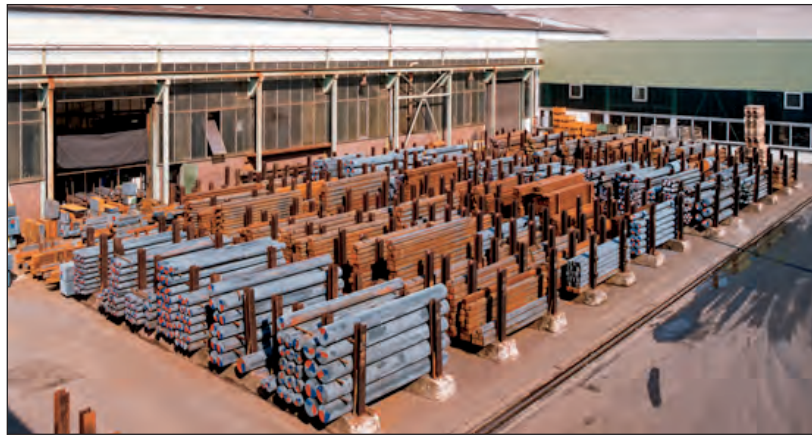
Bild 52: In Stranggusslagern wird von den Gießereien eine Vielzahl verschiedener Profile vorgehalten (Bild: Gontermann-Peipers, Siegen)
