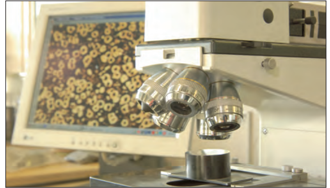
Bild 121: Gefügebestimmung und -kontrolle in einem metallkundlichen Labor einer Eisengießerei (Bild: CLAAS GUSS, Bielefeld)
