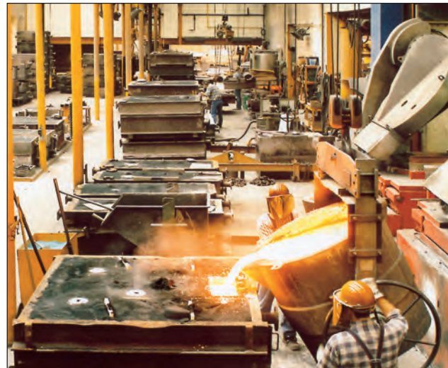
Bild 61: Abgießen einer Form, links im Bild der Induktionsofenschmelzbetrieb mit zwei Schmelzöfen (Bild: Eisengießerei H. Dhonau, Triberg)
