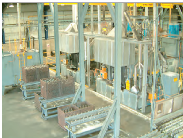
Bild 62: Wärmebehandlungsanlage für ADI-Gusseisen (Bild: ADI Treatment Ltd., West Bromwich)
