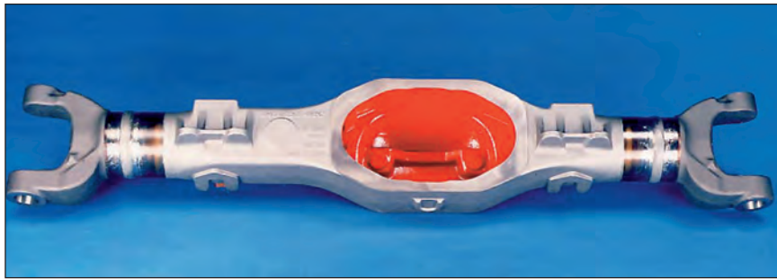
Bild 110: Vorderachskörper aus EN-GJS 400 -18 mit angeschweißten Gelenkstücken aus E295, Positioniergenauigkeit der Gelenkstücke kleiner \pm 1 Grad (Bild: W. Hundhausen, Schwerte)
