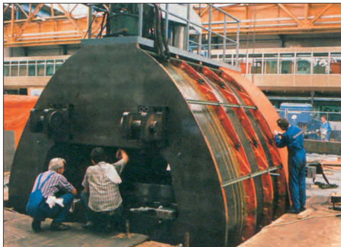
Bild 20: Wickelvorgespannte Konstruktionen sind auch bei Gussteilen aus GJS anwendbar, wie bei diesem Pressenkörper aus GJS-400-18, der für eine Haltekraft von 200 000 kN vorgespannt wurde (Bild: Siempelkamp, Krefeld)
