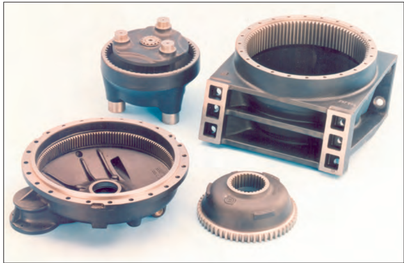
Bild 163: Diverse Bauteile für einen Betonmischerantrieb aus EN-GJS-700-2 und EN-GJS-500-7 im bearbeiteten Zustand mit Verzahnung (Bild: CLAAS GUSS, Bielefeld)
