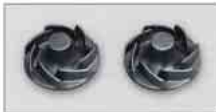
Bild 109: Zwecks besserer Bearbeitbarkeit ferritisch gegläute Flügelräder aus GJL-150 für Pkw-Wasserpumpen
