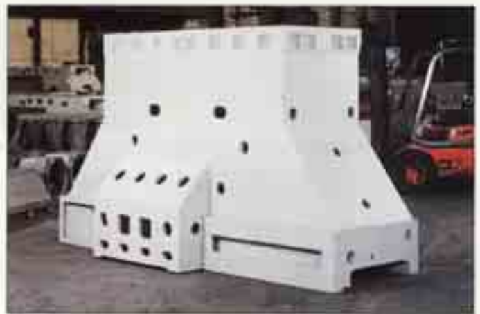
Ständer für eine Fräsmaschine; Werkstoff: GJL-250, Abmessungen: 4510 × 2460 × 1670 mm, Gewicht: 18,5 t
