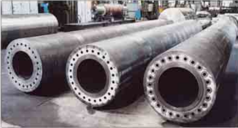
Bearbeitete und mit peripheren Bohrungen versehene Walzen für einen Papierkalandar; Werkstoff: GJL-250, Abmessungen: \varnothing 850/475 x 9300 mm, Gewicht: 19,4 t
