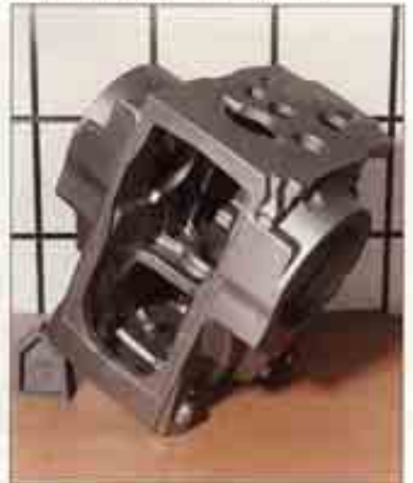
▼ Hinterachsgehäuse aus GJL-250 für einen Traktor, Gewicht: 143,4 kg
