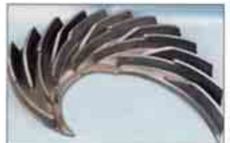
Bild 69: Viertelliger Diffusor aus niedriglegiertem GJL für einen Glühofen, Gesamtgewicht: 720 kg
