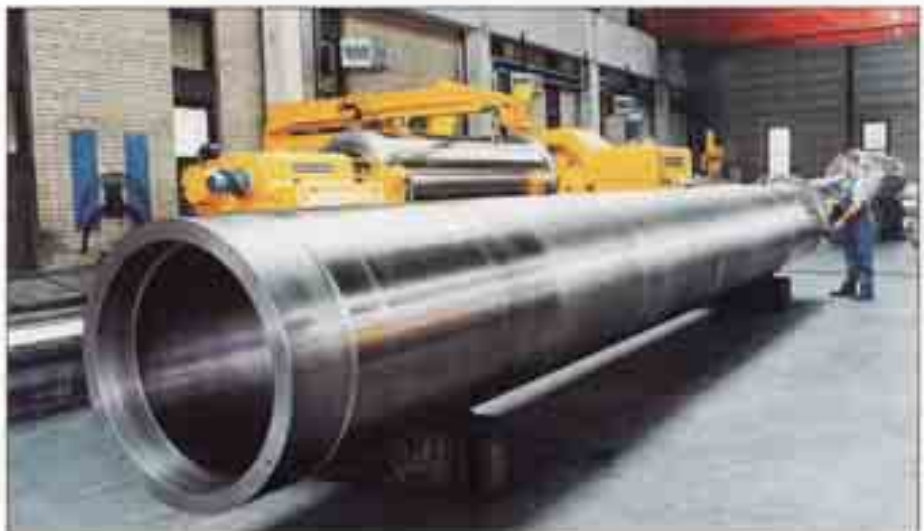
Biegeausgleichsmantel aus GJL-250 für das Glättwerk einer Papiermaschine; Abmessungen: \text{Ø } 980/790 \times 9510 \text{ mm} , Gewicht: 17,9 t
