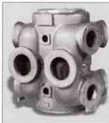
Bild 14: Verdichtergehäuse aus GJL-250, mit 2,5 % Ni legiert; Gewicht: 2,2 t
