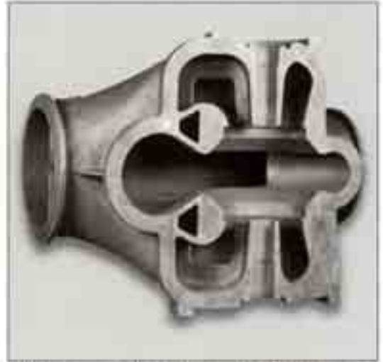
Bild 17: Pumpengehäuse aus mit 2 % Ni legiertem GJL-250; links = Oberteil mit einem Gewicht von 2150 kg, das Gewicht des Unterteils (rechts) beträgt 6,4 t.
