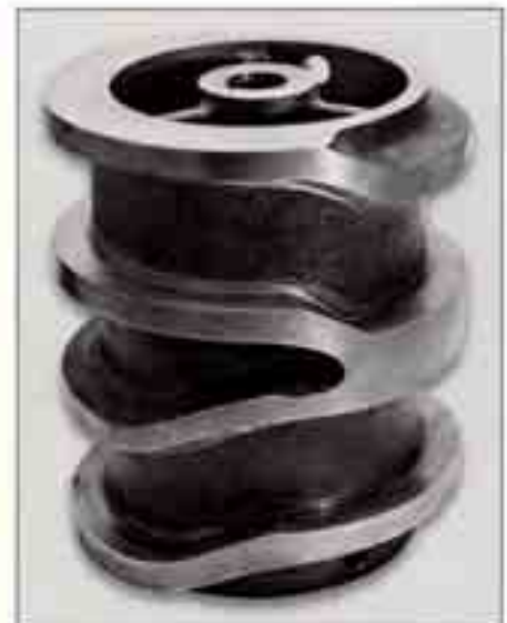
Bild 116: Nitrierte Steuertrummel aus GJL-350, Abmessungen: Ø 320 x 340 mm, Gewicht: 61 kg
