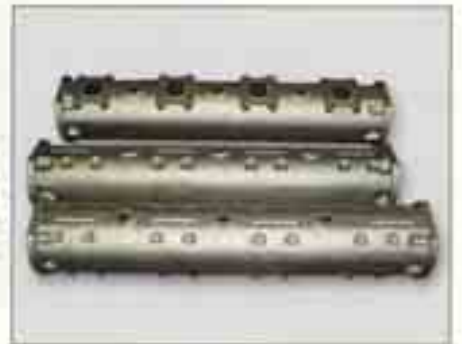
Spiralgehäuse (Ansauggehäuse) für einen Turbolader; Werkstoff: GJL-250, Gewicht: 1,5 t
