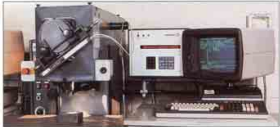
Bild 26: Computergestützte Härteprüfung mit EDV-Terminal und Monitor
