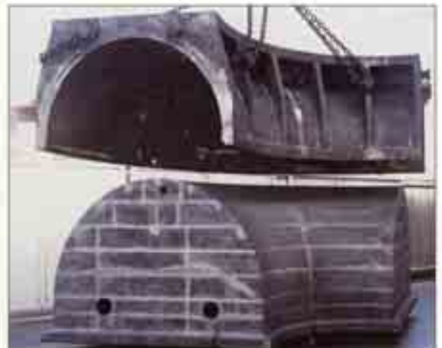
Umformwerkzeug zum Heißverformen von Kraftwerksrohren; Werkstoff: GJL-250, Gewicht Matrize: 40 t, Gewicht Stempel: 32 t
