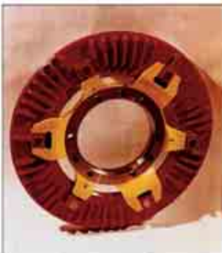
Bild 101: Scheibenbremse Ø 680 mm für Schienenfahrzeuge; der Bremsring aus GJL-250 ist spannungsarm gegläht, die Paßflächen zur Nabe sind auf >48 HRC flammgehärtet
