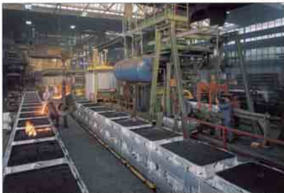
Bild 8: Abgießen an einer hochmechanisierten und teilautomatisierten Formanlage
