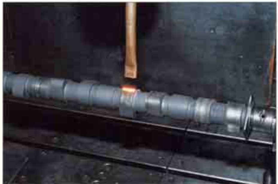
Bild 112: Härten (Umschmelzhärten) der Nocken einer Nockenwelle aus GJL-300 mit dem Laserstrahl; der Brennfleck ist hier zu einer Linie geformt, deren Länge auf die Nockenbreite abgestimmt ist
