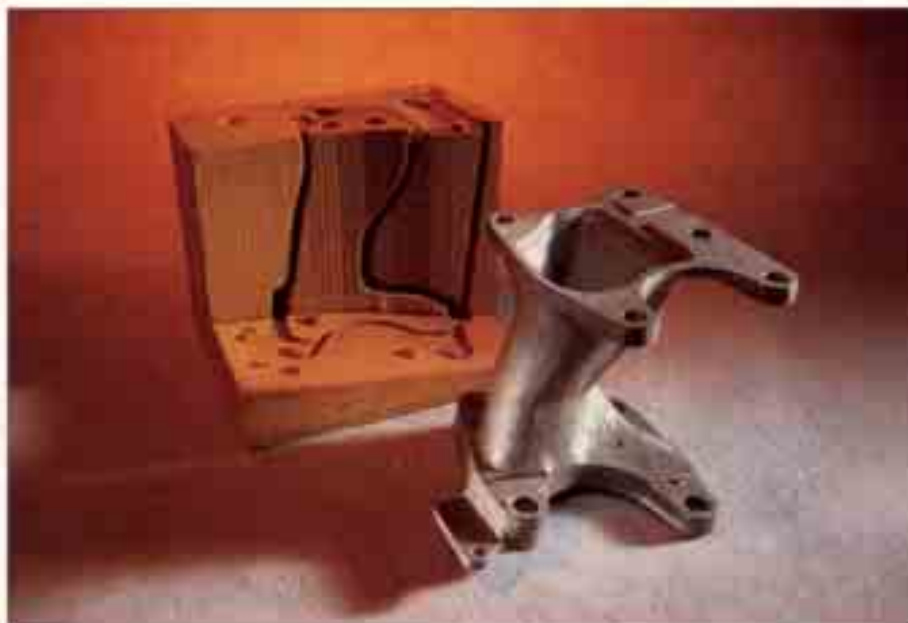
Bild 102: Mit dem Lasersintern erzeugte Form und Kern sowie danach erstelltes Gußstück
