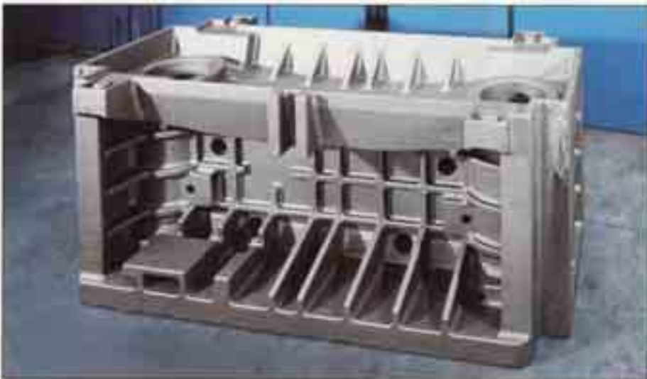
Kopfstück für eine Presse; Werkstoff: GJL-250, Abmessungen: 1900 × 800 × 850 mm, Gewicht: 3,5 t
