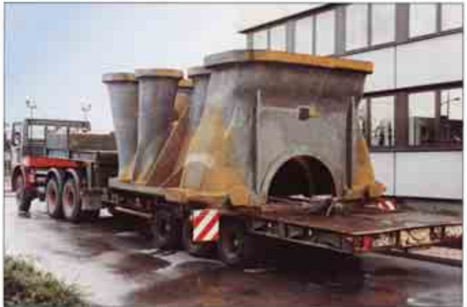
▲ Tisch für eine Presse; Werkstoff: GJL-300, Abmessungen: 2820 × 1160 × 1130 mm, Gewicht: 4,8 t
