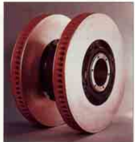
Bild 89: Scheibenbremse für den Hochgeschwindigkeitszug TGV mit Bremsringen aus GJL-250 (640 mm Ø)
