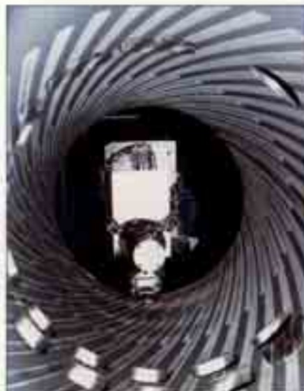
Bild 115: Laufbuchse aus GJL-250 für einen Großdieselmotor, bahnweise lasergehärtet
