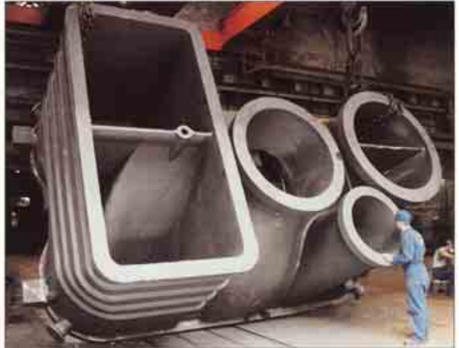
Gehäuse aus GJL-200 für einen Kom- pressor, Gewicht: 51,5 t
