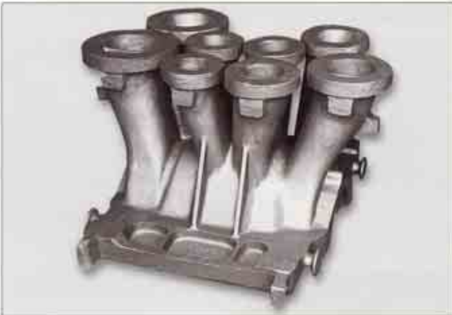
Gehäuse für einen Verdichter, Werkstoff: GJL-350, Gewicht: 3,75 t
