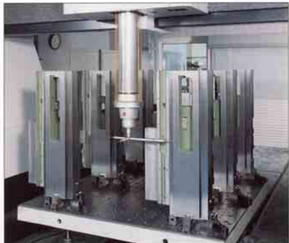
Bild 27: Aufsichtsfreies Messen von 6 Bettschlitten aus GJL-300 auf einer Präzisionsmeßmaschine
