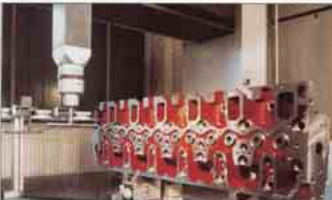
Vermessen eines 940 mm langen Dieselmotor-Zylinderkopfes aus GJL-250, Gewicht: 62 kg
