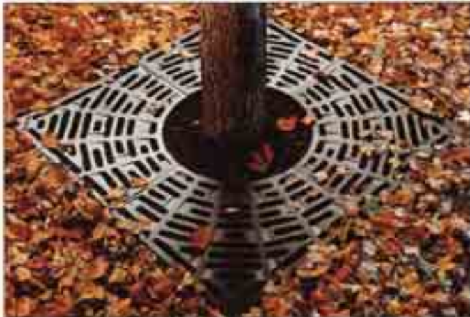
Baumroste aus GJL-200 überkragen freitragend die Baumscheibe und verhindern eine Bodenverdichtung
