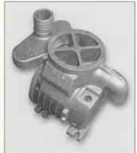
Gehäuse aus GJL-200 für eine Kläranlagen-Abwasserpumpe, Gewicht: 49 kg
