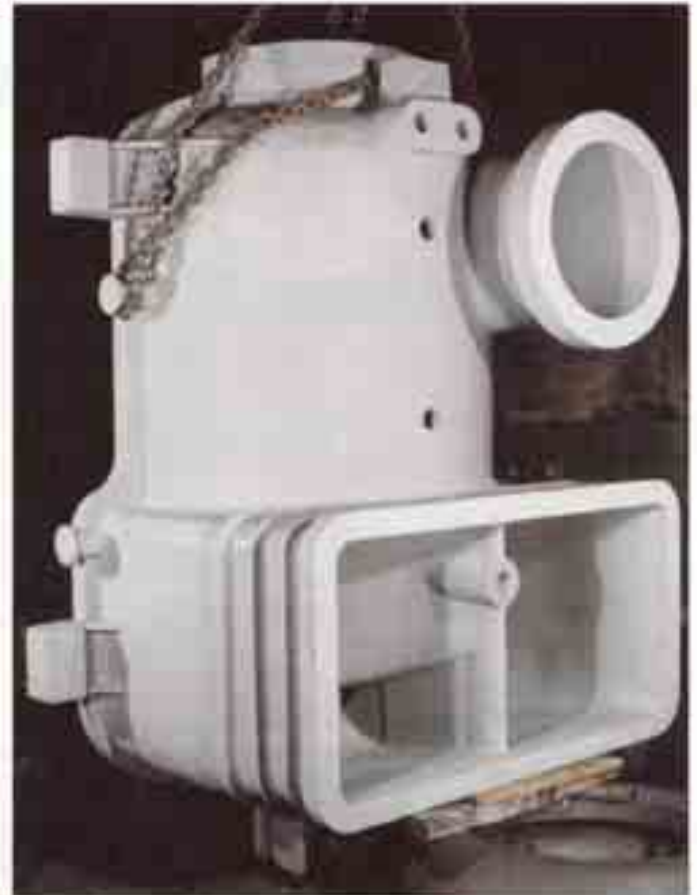
Verdichtergehäuse aus GJL-200, links = Unterteil, Gewicht: 6,6 t, rechts = Oberteil, Gewicht: 6,2 t
