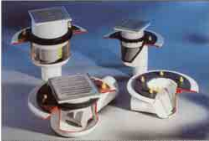
Bodenabläufe (teilgeschnitten) DN 70 und DN 100 mit Preßdichtungsflansch und herausnehmbarem Geruchsverschluss, vollständig aus GJL-200 bestehend
