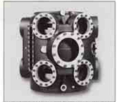
Zylinder aus GJL-250 für einen wassergekühlten Kolbenkompressor, Gewicht: 3,9 t
