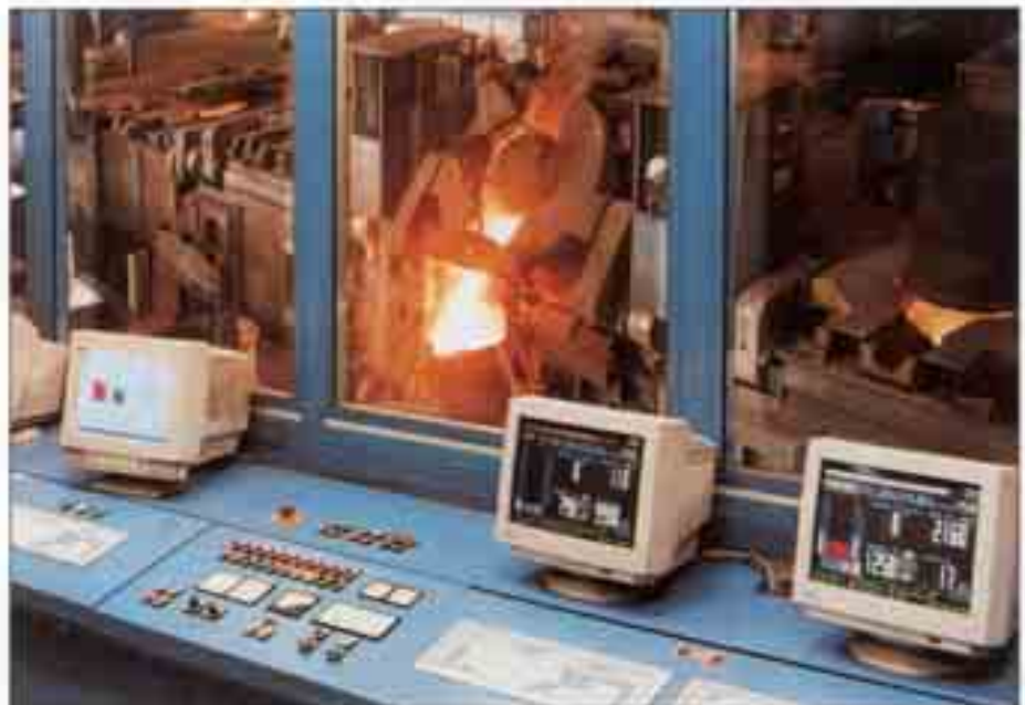
Bild 5: Steuer- und Leitstand einer Elektroschmelzanlage, im Hintergrund der Abstich eines Ofens
