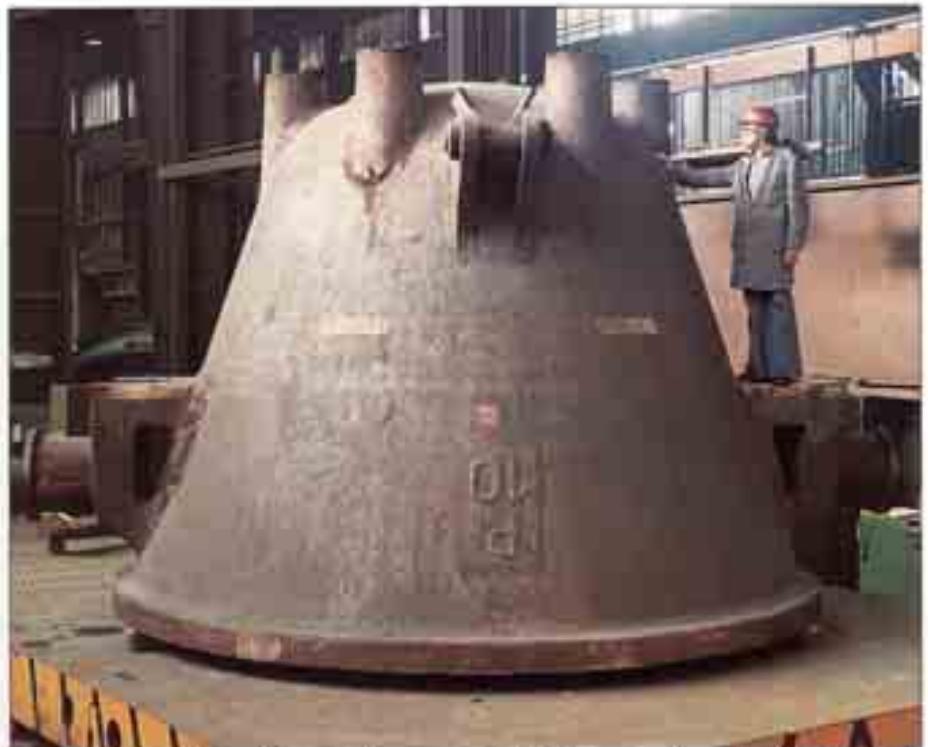
Bild 60: Schlackenkübel für ein Hüttenwerk; Werkstoff: ferritisches GJL, Gewicht: 32,4 t
