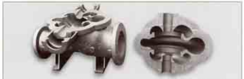
Pumpengehäuse aus GJL-300 (niedriglegiert) mit Stückgewichten von 362 bzw. 144 kg
