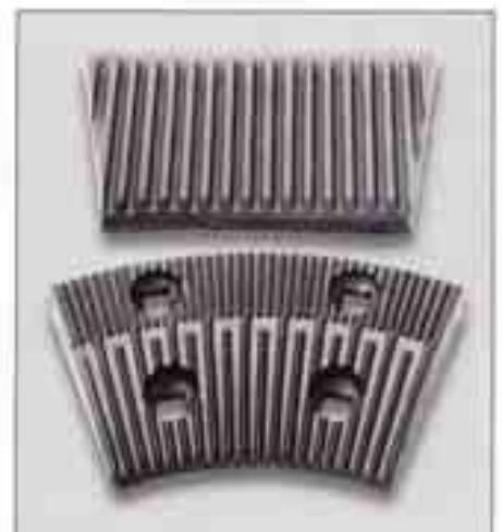
Bild 15: Mahlscheibensegmente aus Cr-legiertem GJL-300, Stückgewicht: 10,6 kg
