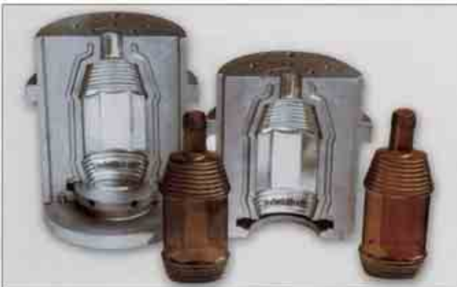
Bild 85: Form aus niedriglegiertem Gußeisen mit Lamellengraphit zur Herstellung von Glasflaschen
