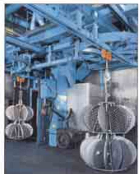
Bild 11: Hängebahnsystem für das Strahlputzen des Rohgusses
