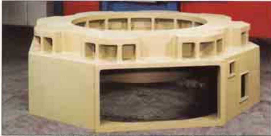
Tischrahmen aus GJL-300 für eine Verzahnungsmaschine, Gewicht: 11,5 t
