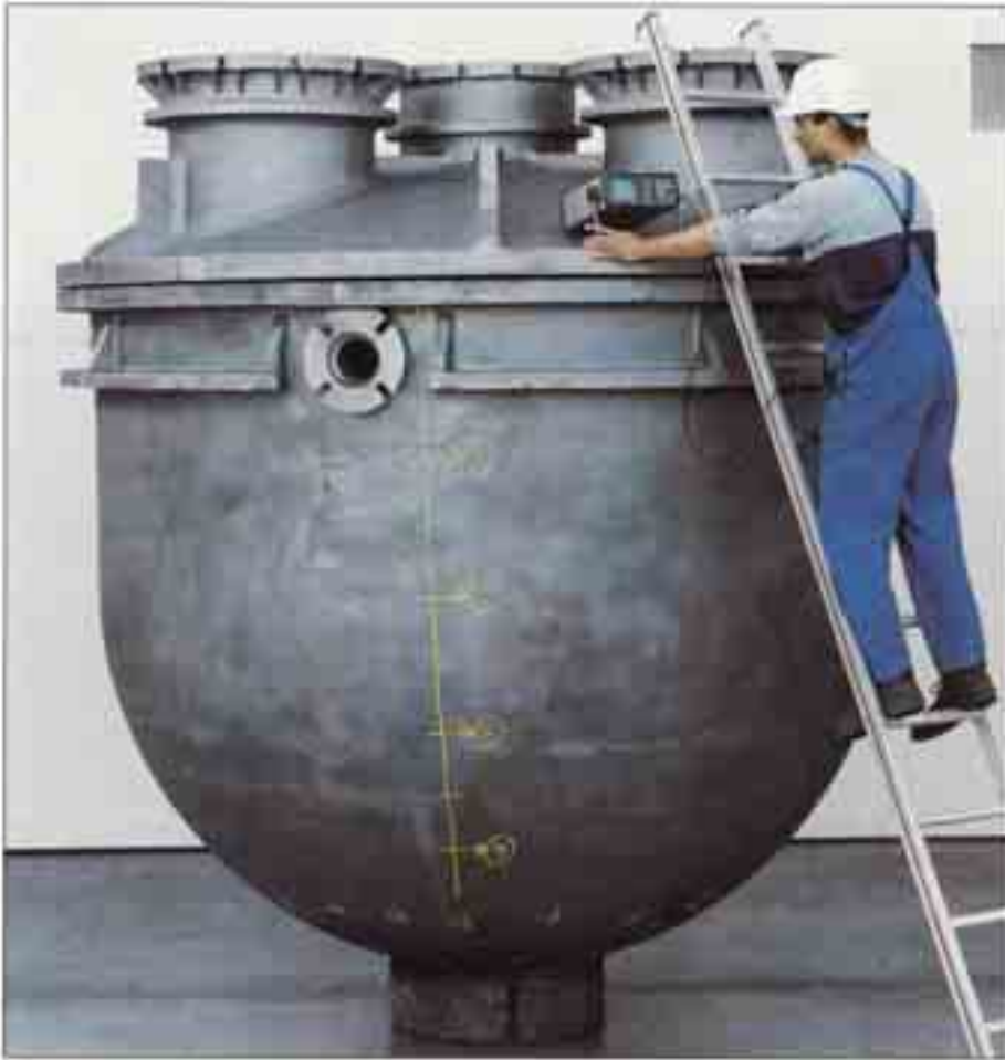
Reaktor aus GJL-250 für die Aufbereitung von Schwefelsäure
