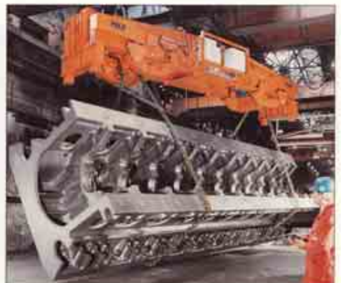
Zylinderkurbelgehäuse für einen Großdieselmotor; Werkstoff: niedriglegiertes GJL-350, Gewicht: 92,6 kg
