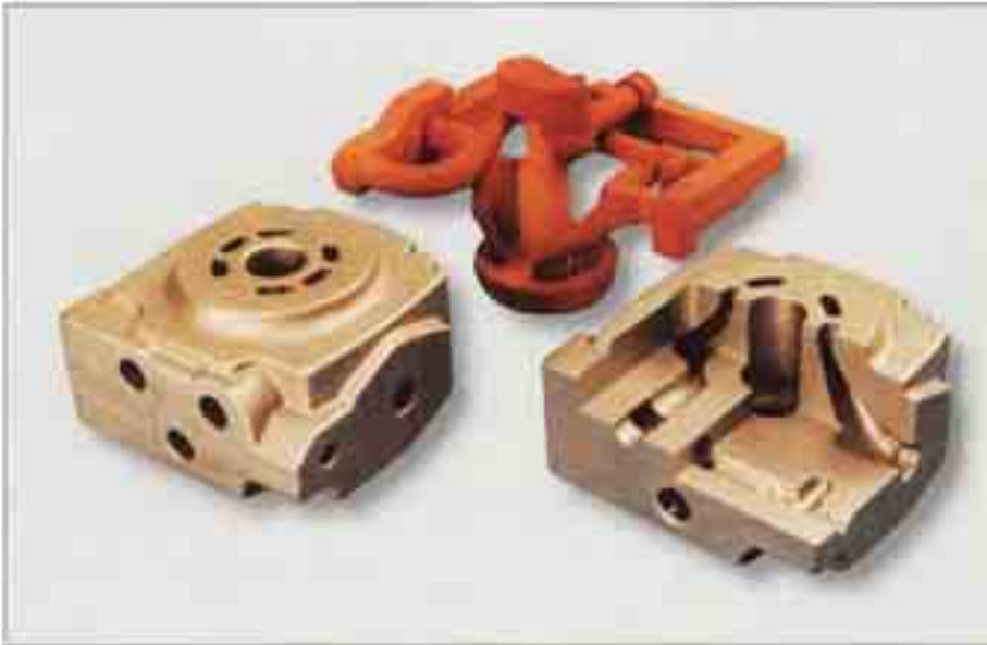
Hydraulik-Steuergehäuse, von links: Ansicht, für die Innenkonturen notwendiger Kern und Schnitt; Werkstoff: GJL-300 (niedrig NiCu-legiert), Gewicht: 10,2 kg
