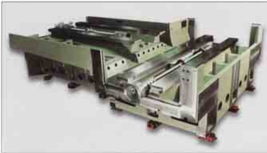
Bei diesem teilmontierten Bett für eine Werkzeugmaschine spielt GJL seine volle Leistungsfähigkeit aus: Freizügigkeit der Gestaltung, günstige mechanische Eigenschaften, hohes Dämpfungsvermögen und Wirtschaftlichkeit.
