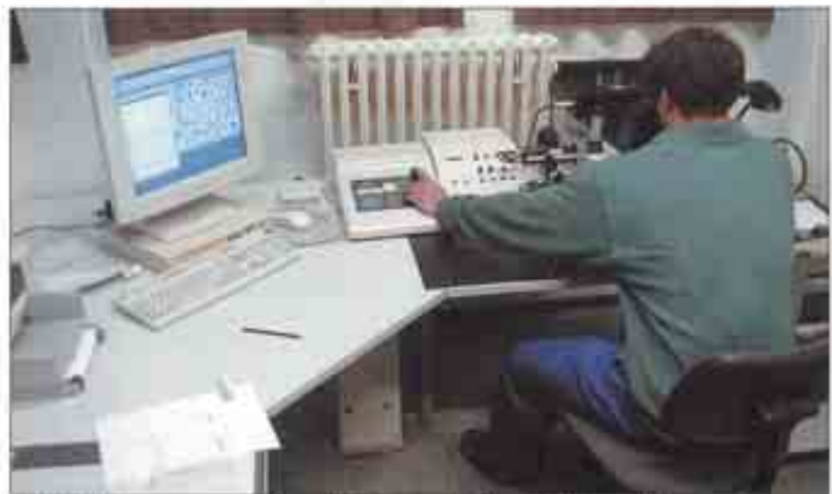
Bild 23: Anlage zur computergestützten quantitativen Gefügeanalyse
