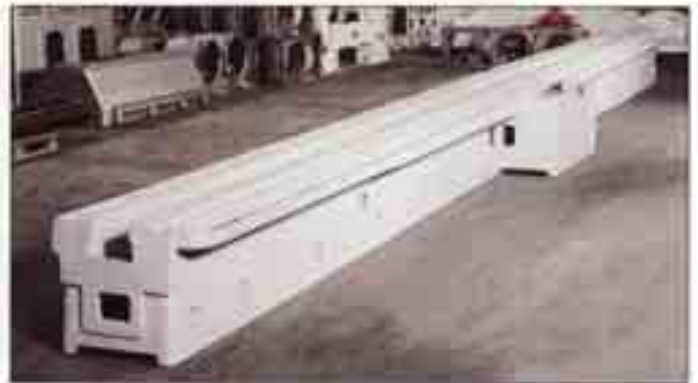
Maschinenbett für eine Schleifmaschine; Werkstoff: GJL-250, Abmessungen: 13300 × 765 × 1230 mm, Gewicht: 14,4 t
