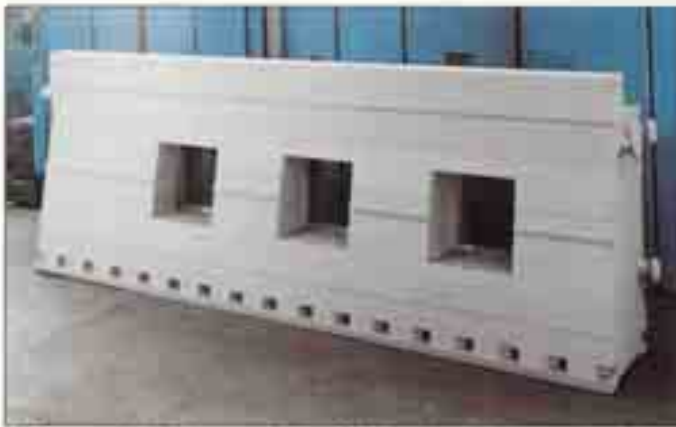
Seitenwandständer aus GJL-250 für eine Hochgeschwindigkeits-Fräsmaschine; Abmessungen: 1900 × 800 × 850 mm, Gewicht: 3,5 t
