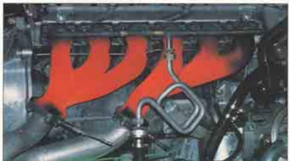
Bild 57: Abgaskrümmter aus Gußeisen mit Lamellengraphit bei der Erprobung
