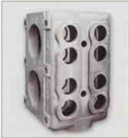
Gehäuse für einen Schraubenverdichter; Werkstoff: GJL-250, Abmessungen: 920 × 580 × 820 mm, Gewicht: 380 kg
