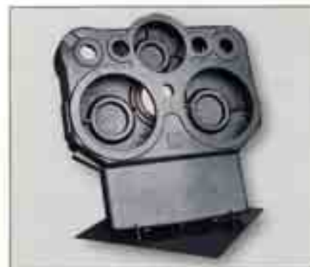
Bild 77: Getriebegehäuse aus G.J.L-250 für einen Bagger; Abmessungen: 1400 \times 1400 \times 400 mm, Gewicht: 705 kg
