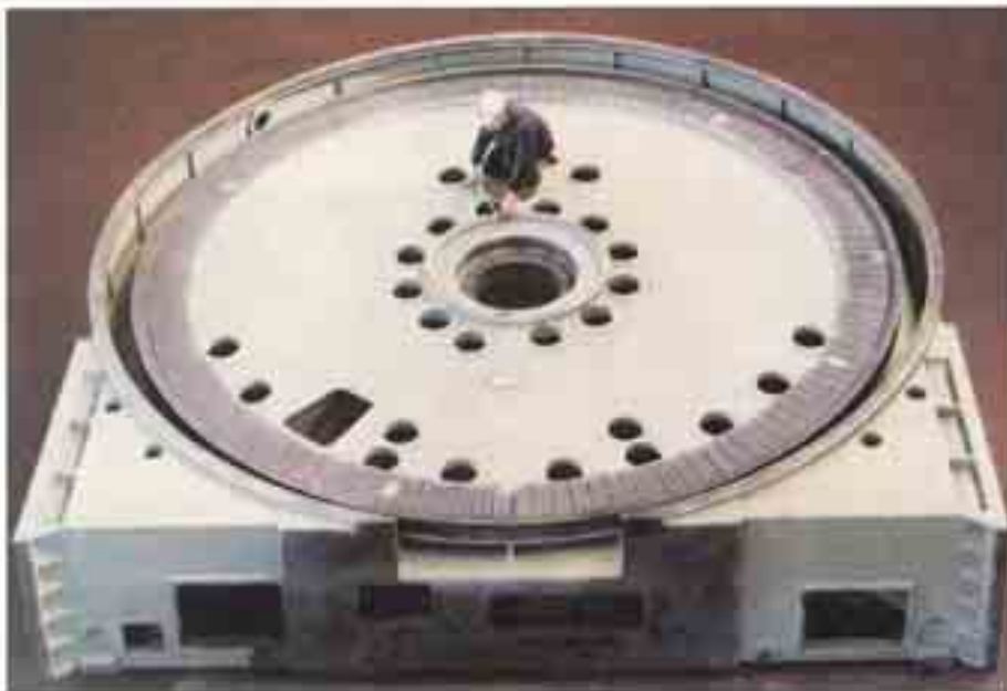
Bild 53: Untergestell für eine Karusselldrehmaschine; Werkstoff: GJL-200, 5800 mm Ø, Gewicht: 44 t
