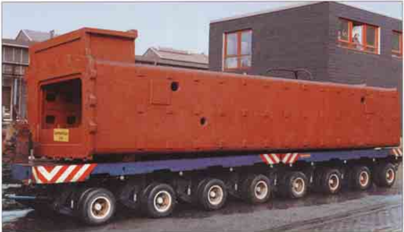
Ständer für eine Portal-Fräsmaschine; Werkstoff: GJL-300, Länge: 8150 mm, Gewicht: 95,4 t
