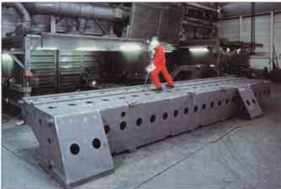
Querbalken für eine Portalfräsmaschine; Werkstoff: GJL-250, Abmessungen: 10.600 × 2400 × 1100 mm, Gewicht: 27,5 t
