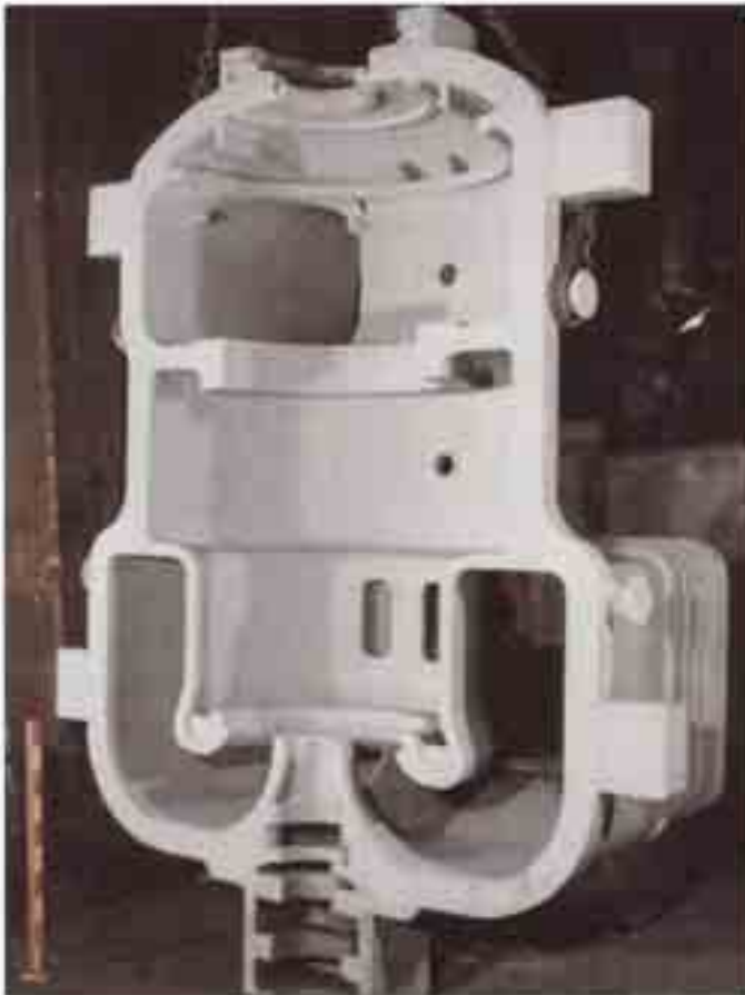
Verdichtergehäuse aus GJL-200, links = Unterteil, Gewicht: 6,6 t, rechts = Oberteil, Gewicht: 6,2 t
