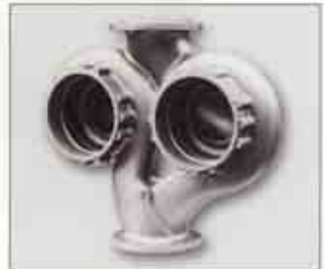
Gehäuse aus GJL-300 für eine Wasserpumpe, Gewicht: 143 kg
