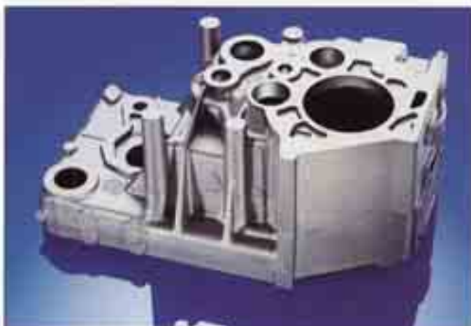
Schalt- und Steuergehäuse aus GJL-250 für eine Baumaschine, Gewicht: 221 kg
