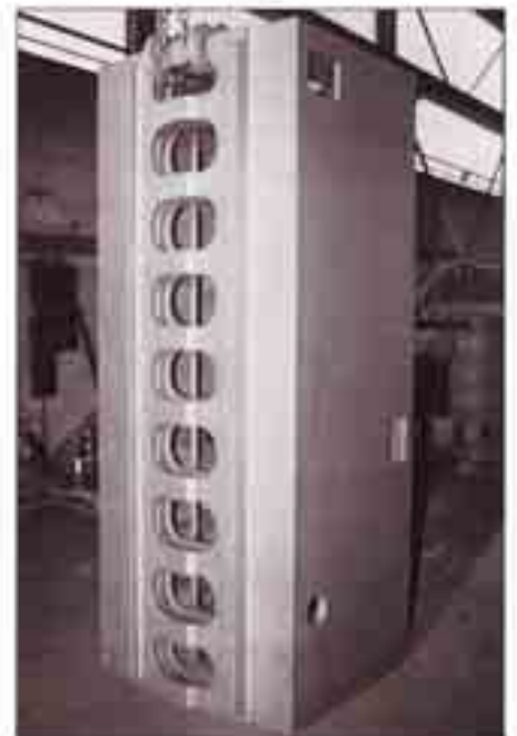
Vertikalständer für eine Rundtisch-Schleifmaschine; Werkstoff: GJL-300, Gewicht: 4,2 t, Abmessungen: 2700 × 1060 × 1200 mm
