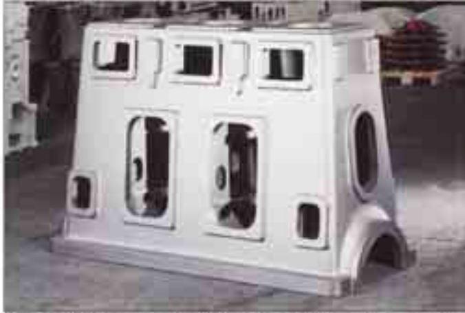
Kurbelgehäuse aus GJL-250 für einen dreistufigen Verdichter; links = Oberteil, 2320 × 1000 × 1520 mm, 2830 kg; rechts = Unterteil, 2320 × 1000 × 820 mm, 1530 kg
