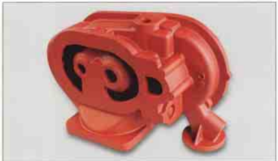
Saugseitenplatte für einen Verdichter; Werkstoff: GJL-250, Abmessungen: 730 × 465 × 330 mm, Gewicht: 140 kg
