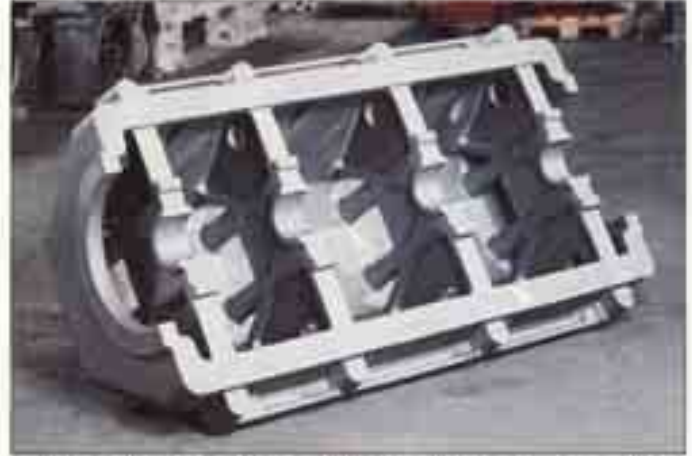
Kurbelgehäuse aus GJL-250 für einen dreistufigen Verdichter; links = Oberteil, 2320 × 1000 × 1520 mm, 2830 kg; rechts = Unterteil, 2320 × 1000 × 820 mm, 1530 kg
