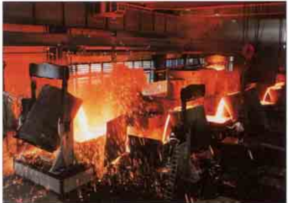
Bild 4: Gleichzeitiger Abguß eines Großwerkstücks aus fünf Pfannen
