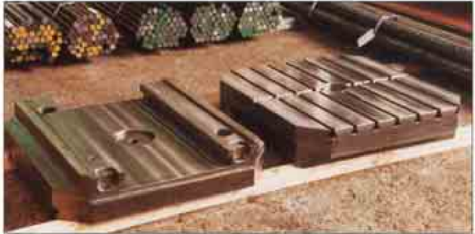
Palettentische für ein Bearbeitungszentrum; Werkstoff GJL-350, Abmessungen: 1200 \times 1200 \text{ mm}
