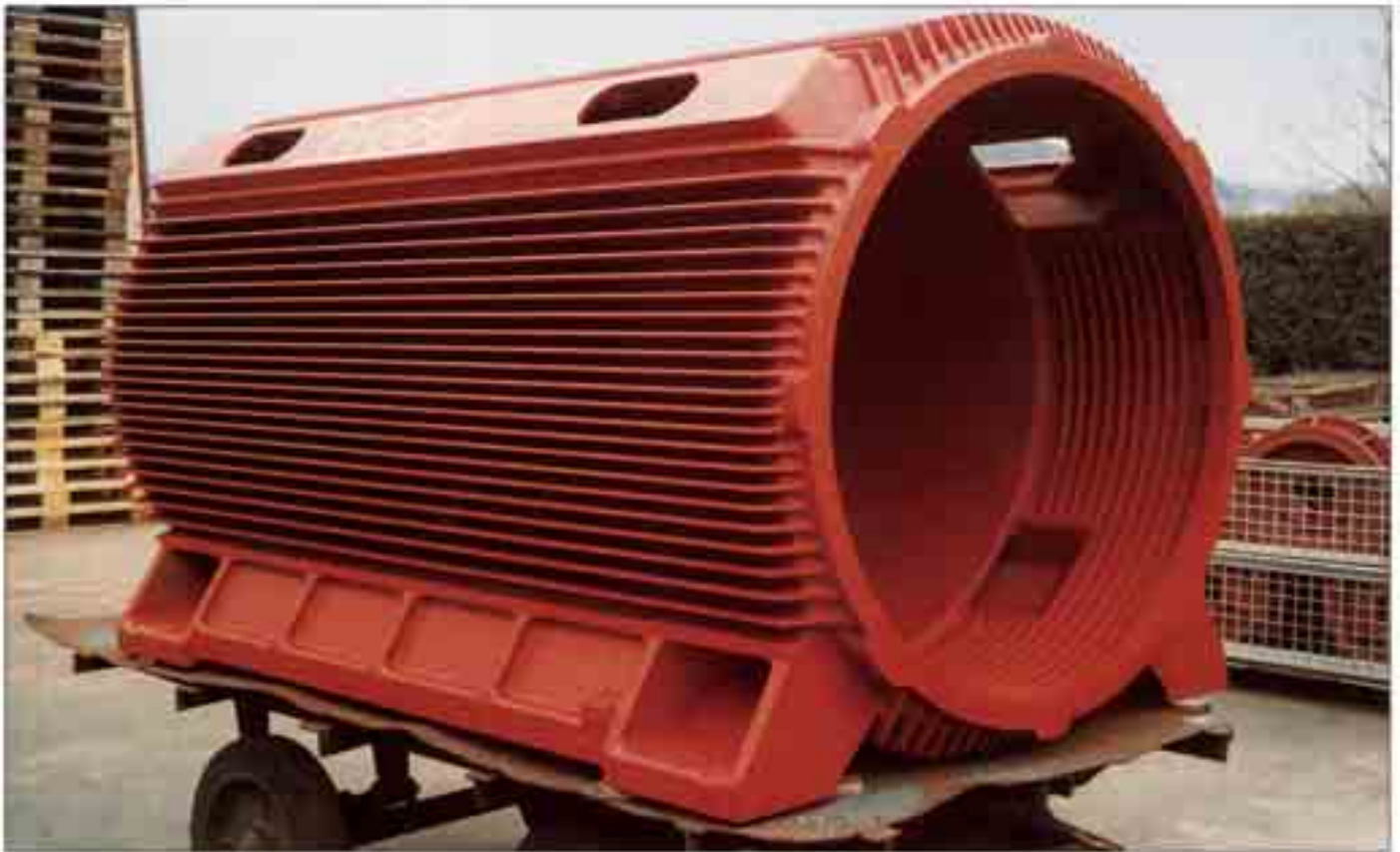
Bild 84: Derzeit weltgrößtes Ständergehäuse für einen Elektromotor mit einer Leistung von 3000 kW; Werkstoff: GJL-200, Abmessungen: \varnothing 1260 \times 2130 mm, Gewicht: 3,5 t
