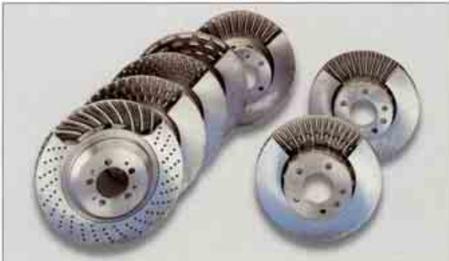
Mit GJL – unlegiert und niedriglegiert – können problemlos und kostengünstig die unterschiedlichsten Kanalförmungen von innenbelüfteten Kfz.-Bremsscheiben realisiert werden.
