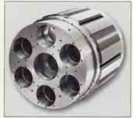
Spindelträger für Mehrspindel-Drehautomat, Gewicht: 140 kg, Werkstoff: ferritisches GJL (Kokillenguß)
