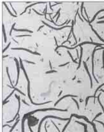
Bild 1: Die typischen Mikrogefüge von Gußeisen mit Lamellengraphit (GJL), links = ferritisches, rechts = perlitisches Grundgefüge jeweils mit eingelagerten Graphitlamellen; V = 200 : 1
