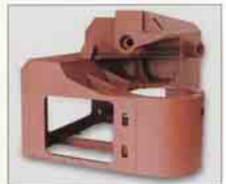
Ständer aus GJL-200 für eine Lebensmittelmaschine; Gewicht: 1450 kg bei mittleren Wanddicken von nur 15 mm
