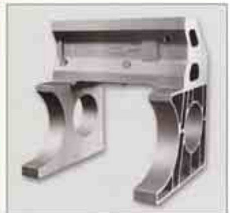
Portal für eine Erodiermaschine; Werkstoff: GJL-250, Abmessungen: 1125 x 1400 x 1450 mm, Gewicht: 1214 kg
