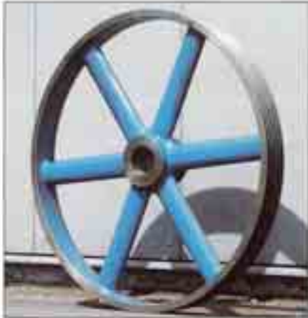
Riemenscheibe aus GJL-250, Abmessungen: \text{Ø } 1410 \times 136 \text{ mm} , Gewicht: 520 kg
