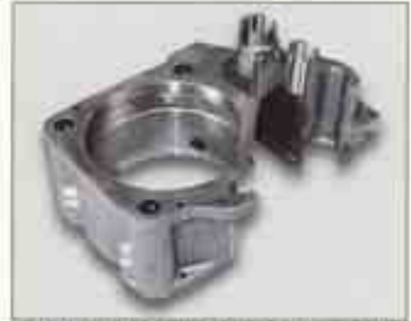
Zylindermantel aus Cu-legiertem GJL-300 für einen Dieselmotor; Abmessungen: 600 × 500 × 400 mm, Gewicht: 92 kg
