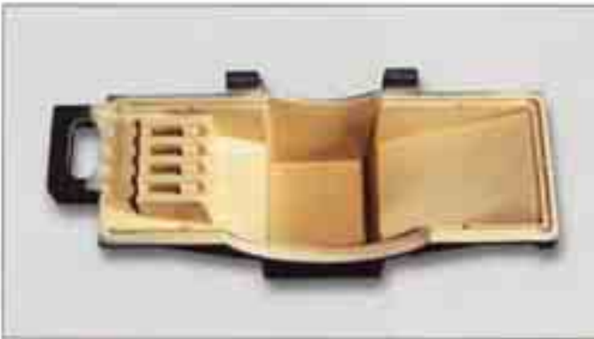
Gehäuse aus GJL-200 für eine Textilmaschine; Abmessungen: 620 × 290 × 255 mm, Gewicht: 48 kg
