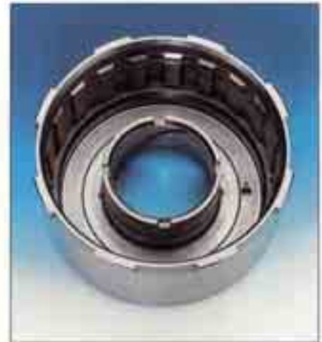
Fertigbearbeitete Getriebetrommel aus GJL-250 für ein Automatikgetriebe der oberen Leistungsklasse; Abmessungen: \varnothing 144,3 \text{ mm} \times 74 \text{ mm} , min. Wanddicke: 2,0 mm
