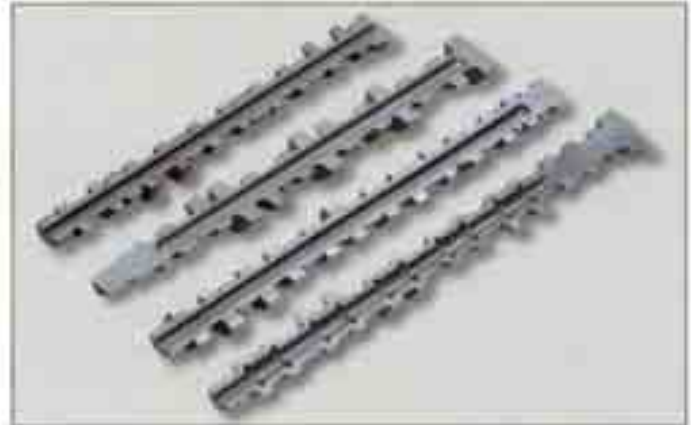
Verschiedene Ausführungen von aus GJL-250 (Schalenhartguß) hohlgegossenen Nockenwellen für Pkw-Motoren, geschnitten
