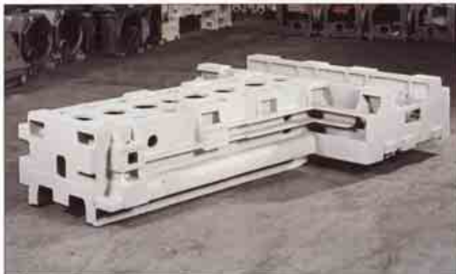
Palette (Unterseite) aus GJL-300 für ein Bearbeitungszentrum; Abmessungen: 630 × 630 × 150 mm
