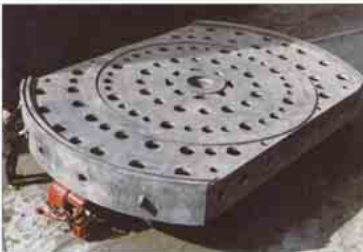
Planscheiben-Mittelstück für eine Karussell-Drehmaschine; Werkstoff: GJL-300, Abmessungen: \varnothing 8000 \times 800 mm, Gewicht: 70,5 t
