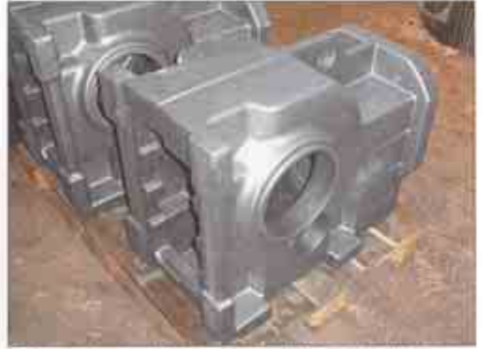
Gehäuse für ein Industriegetriebe; Werkstoff: GJL-250, Gewicht: 260 kg
