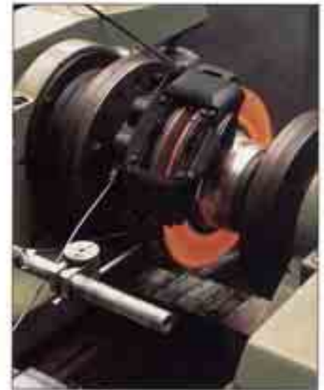
Bild 68: Bremscheibe aus GJL-150 auf dem Prüfstand
