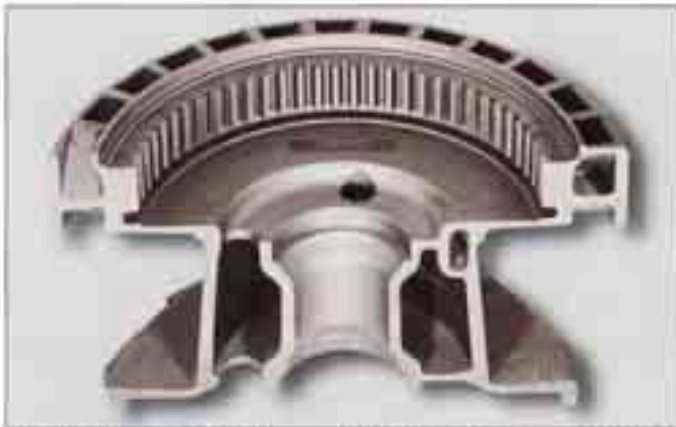
Schnitt durch eine Seiteltrommel für einen Bagger; Werkstoff: GJL-300, Gewicht: 160 kg, 600 mm Außen- \text{Ø}
