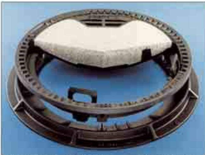
Dreitellige Straßenschachtabdeckung aus GJL-250, Deckel mit Beton ausgegossen
