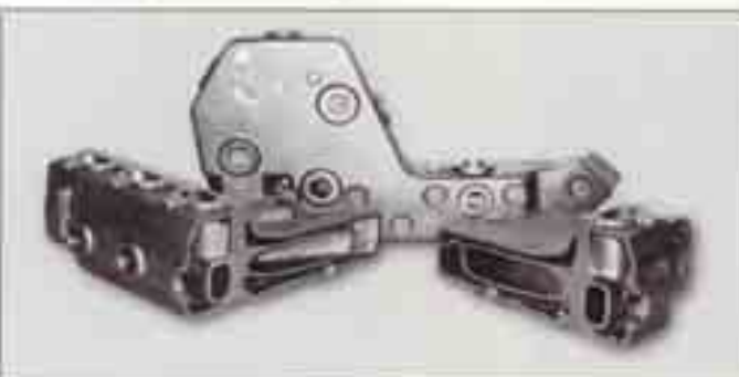
Wassergekühltes Abgasrohr aus niedriglegiertem GJL-150 für einen Schiffmotor, Gewicht: 24 kg
