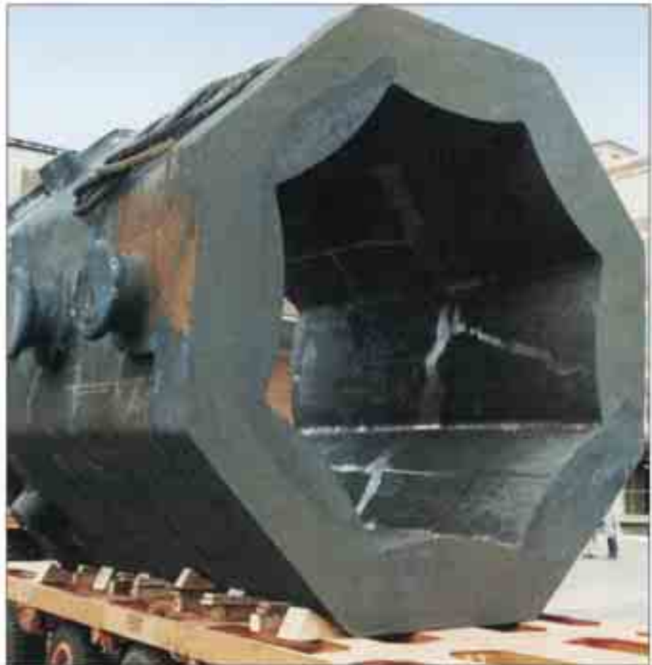
Bild 64: Kokille für einen Schmiedeblock; Werkstoff: ferritisches GJL, Gewicht: 127 t
