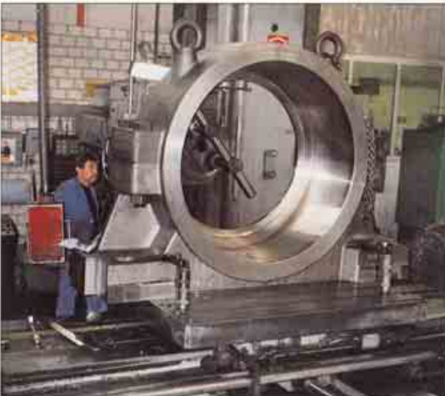
Gehäuse aus GJL-200 für eine Textilmaschine; Abmessungen: 620 × 290 × 255 mm, Gewicht: 48 kg
