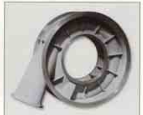
Spiralgehäuse (Ansauggehäuse) für einen Turbolader; Werkstoff: GJL-250, Gewicht: 1,5 t
