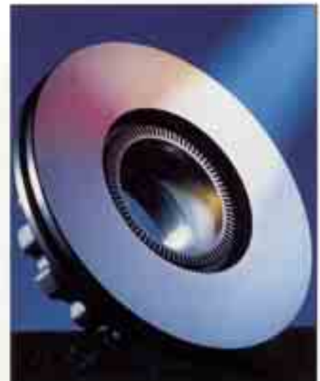
Bild 95: Bremsscheibe mit integriertem ABS-Sensoring für einen Leicht-Lkw, Werkstoff: hochgekohltes niedriglegiertes GJL-150
