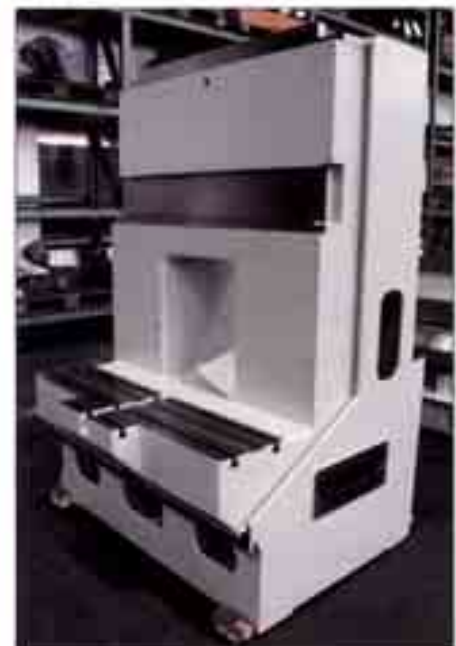
Bild 99: Abguß des nach Bild 96 optimierten Maschinenständers; Abmessungen: 1425 x 1160 x 1990 mm, Gewicht: 2460 kg
