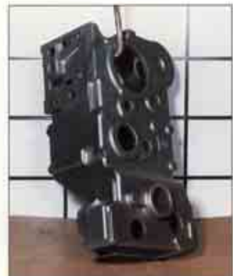
Bild 39: Steuergehäuse aus GJL-200 für eine Baumaschine, Gewicht: 128 kg
