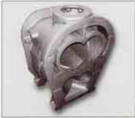
Gehäuse für einen Schraubenverdichter; Werkstoff: GJL-250, Abmessungen: 920 × 580 × 820 mm, Gewicht: 380 kg
