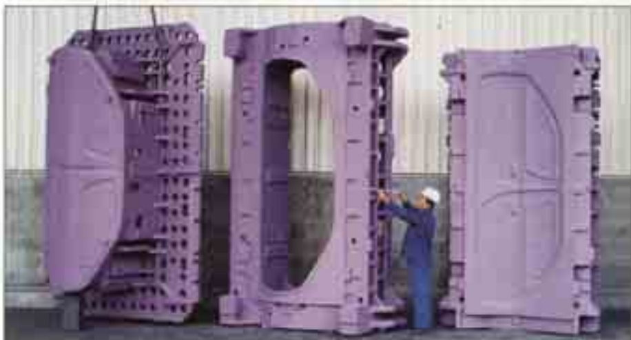
Doppelziehwerkzeug für Pkw-Türen bestehend aus (von links) Stempel (Gewicht: 7 t), Blechhalter (9 t) und Matrize (12 t), Werkstoff: niedrig CrMo-legiertes GJL-250
