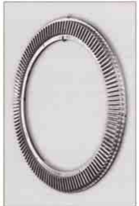
Bild 21: Kegelzahnkranz aus CuNiCr-legiertem GJL-250 mit „Sprengkernen“, Gewicht: 1480 kg
