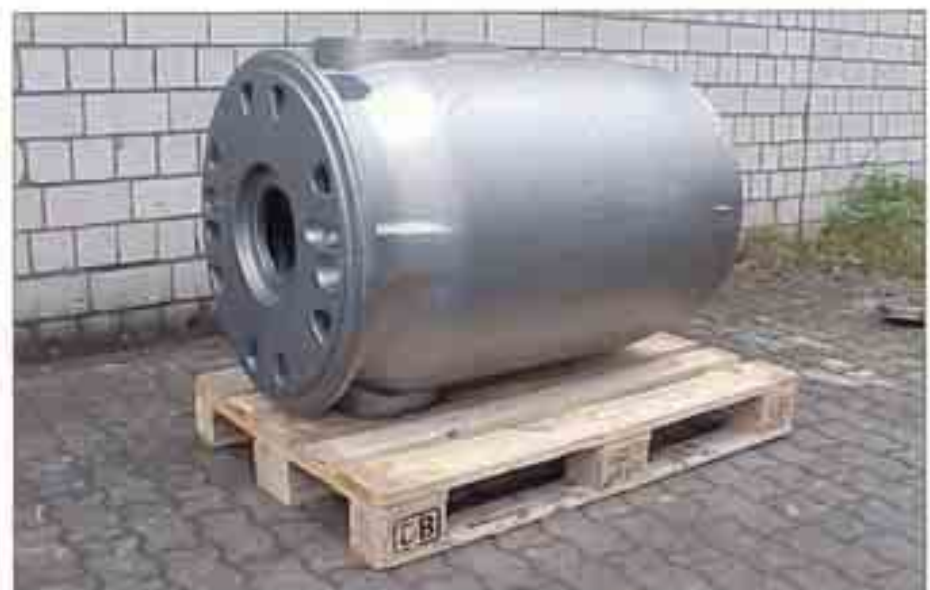
Bild 34: Kühlmantel aus GJL-250 für eine ölgekühlte Tauchpumpe, Gewicht: 550 kg
