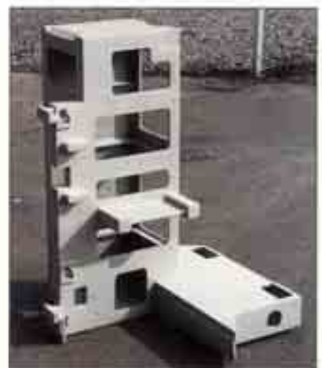
Bild 31: Abrichtständer aus GJL-200 für eine Kehlmaschine, Abmessungen: 1110 x 830 x 830 mm, Gewicht: 192 kg
