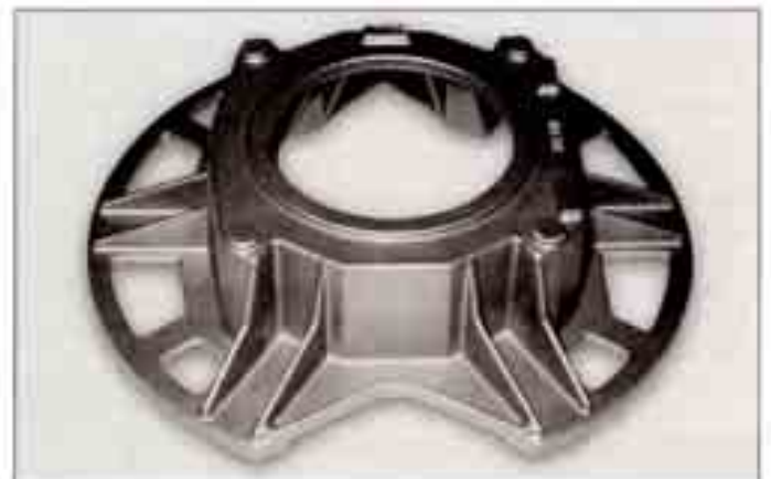
Bild 107: Objektivträger (ferritisch gegläht) für eine Luftbild-Meßkamera; Werkstoff: GJL-100, 320 mm Ø, Gewicht: 7,5 kg
