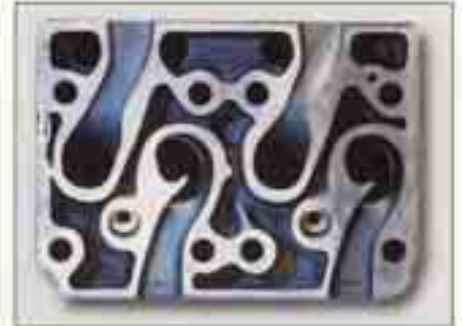
Querschnitt eines Dieselmotor-Zylinderkopfes aus GJL-300; die die Gas-, Wasser- und Ölkannäle trennenden Wände haben eine Dicke von nur wenigen Millimetern.
