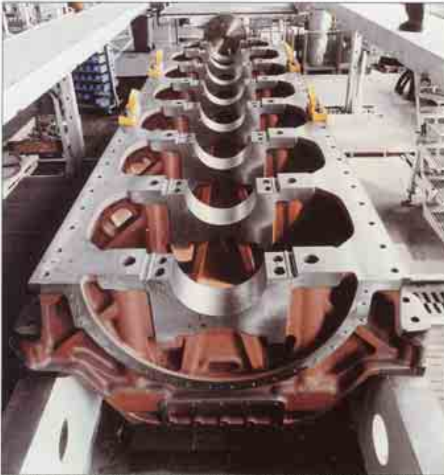
Grundplatte aus niedriglegiertem GJL-350 für einen Großdieselmotor, Gewicht: 9,4 t
