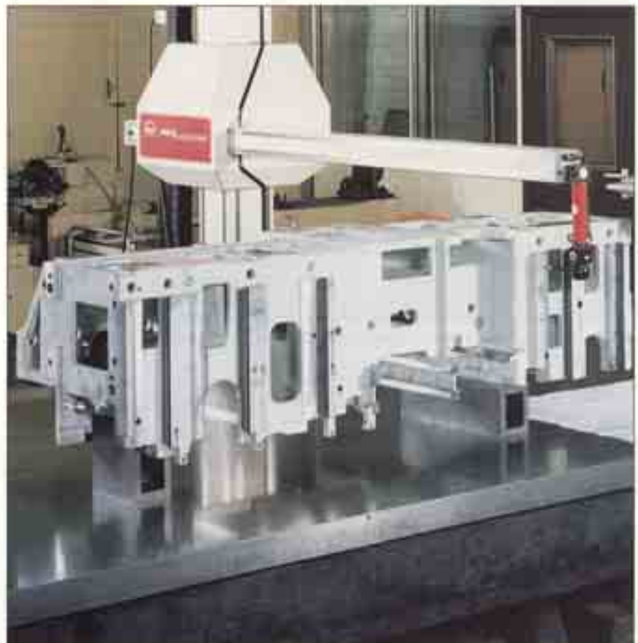
Bild 51: Vermessen des fertigbearbeiteten Ständers für eine Holzbearbeitungsmaschine; Werkstoff: GJL-200, Abmessungen: 2140 × 705 × 650 mm, Gewicht: 598 kg
