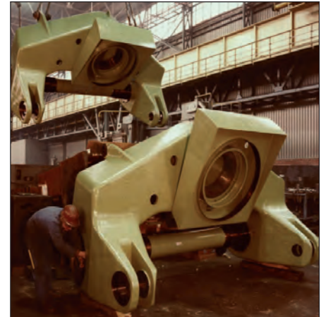
Schwinghebel für Mühlen aus GE240, Masse 13,1 t, Abmessungen 3,56 x 2,02 x 1,67 m
