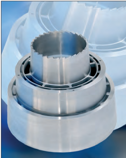
Produktverteiler - ursprünglich eine Schweißkonstruktion, jetzt ein Stahlgussstück aus dem Duplexstahl GX2CrNiMoN22-5 im Keramikformverfahren gefertigt
