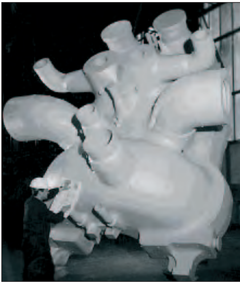
Bild 70: Außengehäuse einer Turbine mit angeschweißten Krümmern aus G17CrMoV5-10
