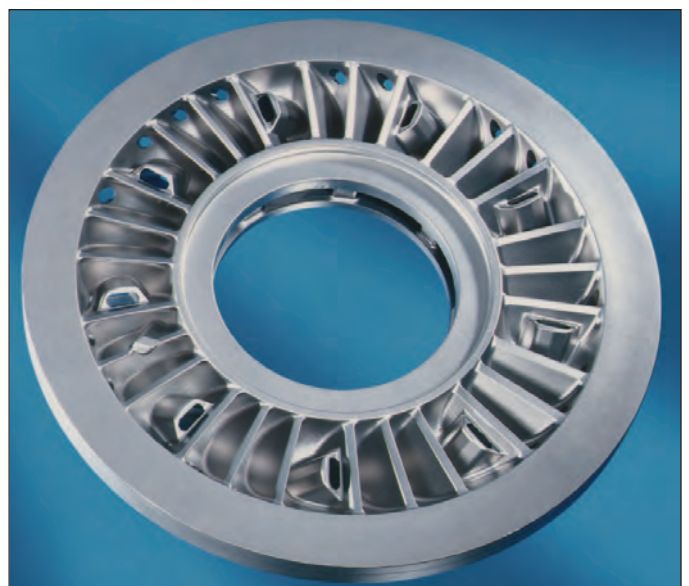
Bild 20: Feingussteil Stator für eine Strömungsbremse (Retarder) mit 320 mm Dmr. aus GX45CrNiW18-9
