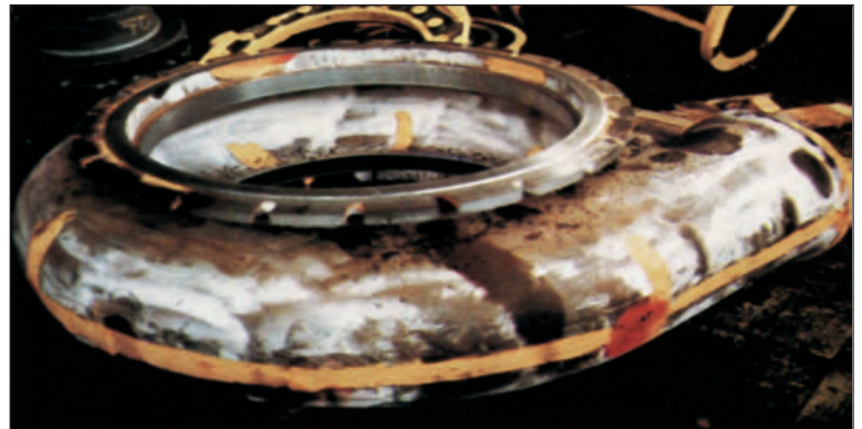
Bild 101: Gehäuse aus verschleißfestem Chromhartguss für eine Nassbaggerpumpe; Masse 2400 kg
