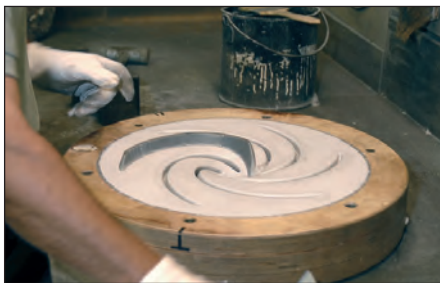
Bild 4: Fertigung von Keramikgießform und Kernen für das Bauteil „Produktverteiler“ aus Duplexstahlguss GX2CrNiMoN22-5.
