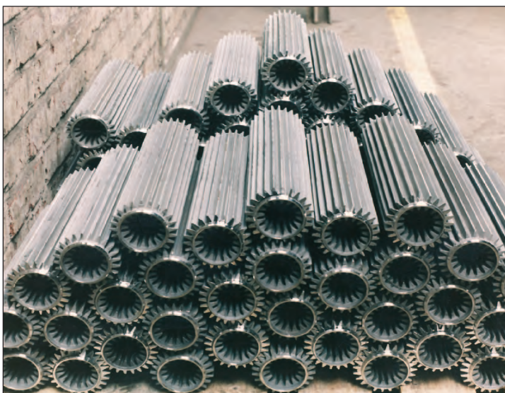
Segmente für Rekuperatoren, die zu kompletten Strahlheizrohren für Industrieöfen verschweißt werden, aus GX40CrNiSi22-9, Segmentmasse 7,5 kg
