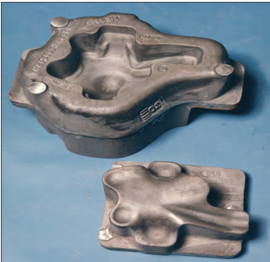
Ober- und Unterteil eines Vorpresswerkzeuges zum Herstellen von Pkw-Achsschenkeln
