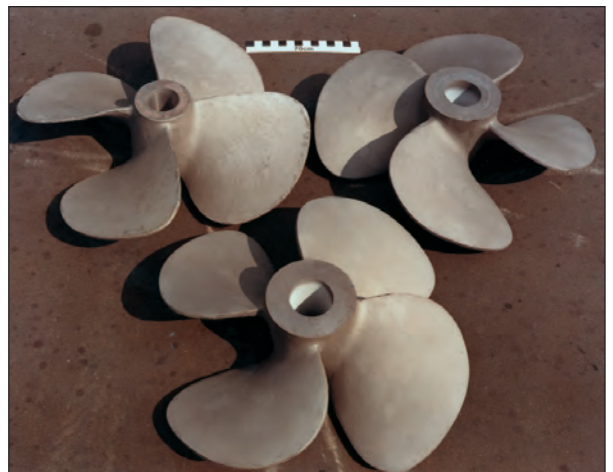
Lüfterräder für Großmotoren aus Stahlfeinguss, Werkstoff GX5CrNiMo16-5, Masse etwa 14 kg (links)
