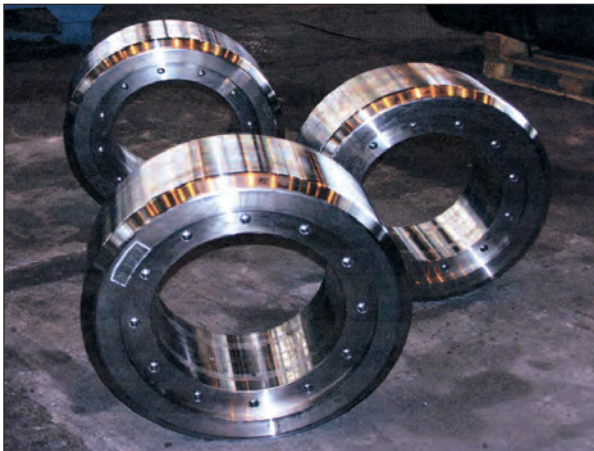
Walzenringe aus perlitischem Stahlguss erzielen durch eingelagerte Carbide hohe Festigkeitswerte
