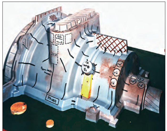
Bild 11: Holzmodell für ein Dampfturbinengehäuse mit eingezeichneter Gießtechnik
