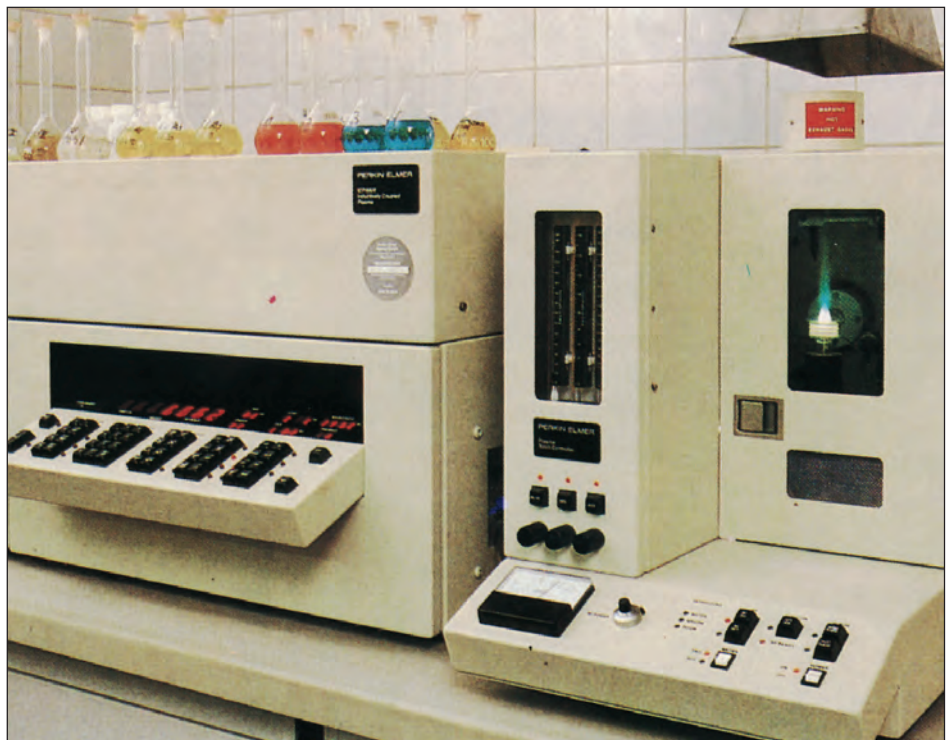
Bild 42: Spektralanalyseanlage mit Plasmaregelung zur Untersuchung der chemischen Zusammensetzung
