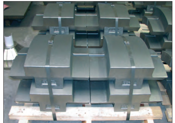
Schwinghebel für Mühlen aus GE240, Masse 13,1 t, Abmessungen 3,56 x 2,02 x 1,67 m
