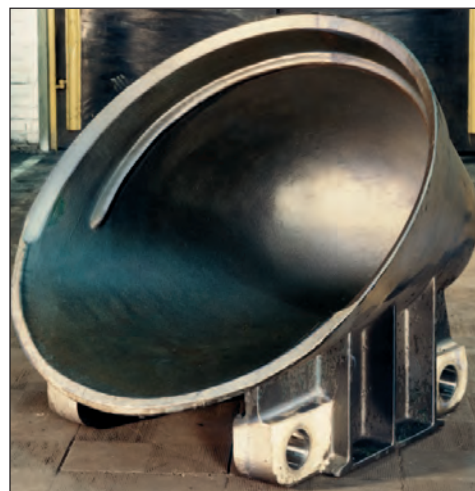
Baggereimer für einen Schwimmbagger mit einem Durchmesser von 1,7 m aus G50MnCr4-4,
