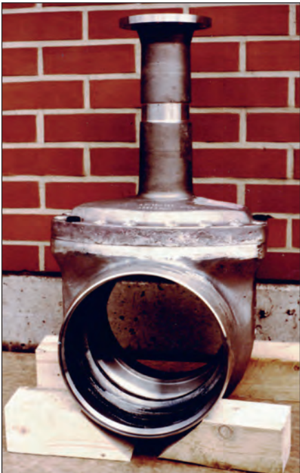
Bild 74: DN-12“-Absperrgehäuse aus kaltzähem Stahlguss nach ASTM A 351 CF 8 M für flüssige Gase bis -196 °C; Masse 140 kg
