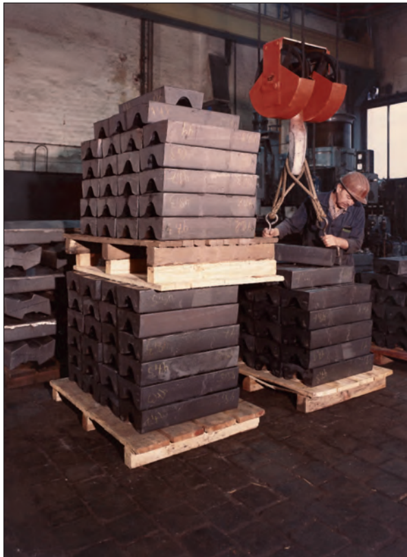
Bild 100: Schlagleisten aus verschleißbeständigem Chromhartguss; Stückmasse 104 kg
