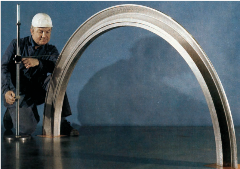
Bild 89: Ringhälfte für eine Gasturbine aus hitzebeständiger Nickel-Basislegierung mit 2000 mm Dmr.; Masse 192 kg
