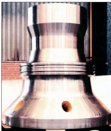
Bild 58: Schlaghaube aus GX5CrNi13-4 zum Einrammen von Rohren; Masse 28 t
