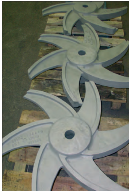
Auflöseräder für die Papierindustrie der Abmessungen 300 bis 2000 mm, Masse von 30 bis 2000 kg, Werkstoff: GX5CrNiMoNb19-11-2
