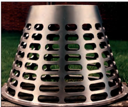
Zentrifugentrommel aus GX2CrNiMoN17-13-4, Masse 500 kg
