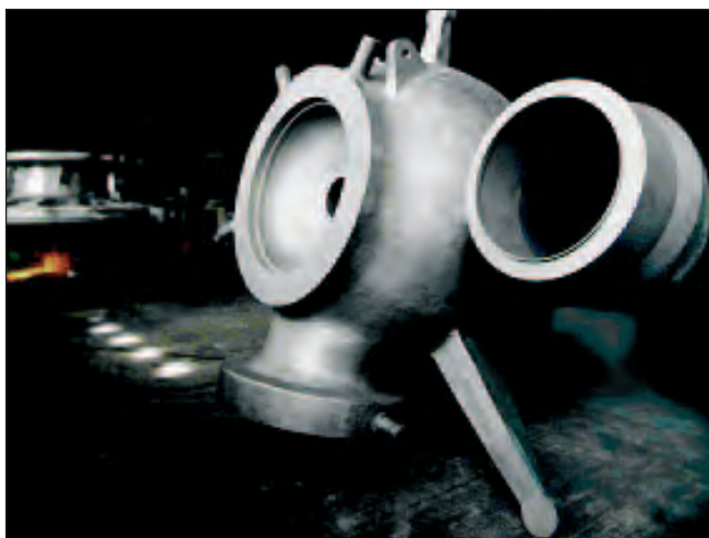
Bild 67: Ventilgehäuse aus GX12CrMoWVNbN10-1-1; Masse 27 t
