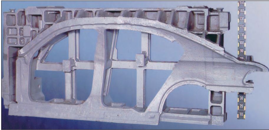
Bild 106: Werkzeug aus G60CrMoV10-7 (1.2320) vergütet auf 850 bis 1000 N/mm 2
