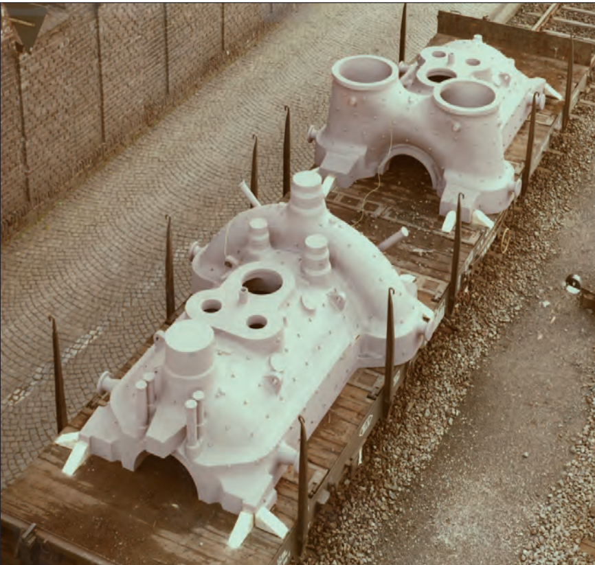
Ober -und Unterteil einer Dampfturbine aus G17CrMo5-5, Masse etwa 90 t
