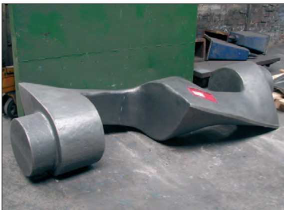
Zentrifugentrommel aus GX2CrNiMoN17-13-4, Masse 500 kg
