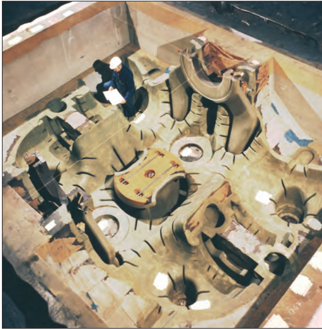
Bild 2: Komplexe Formhälfte mit diversen Kernen für ein großes Turbinengehäuse-Unterteil aus Stahl
