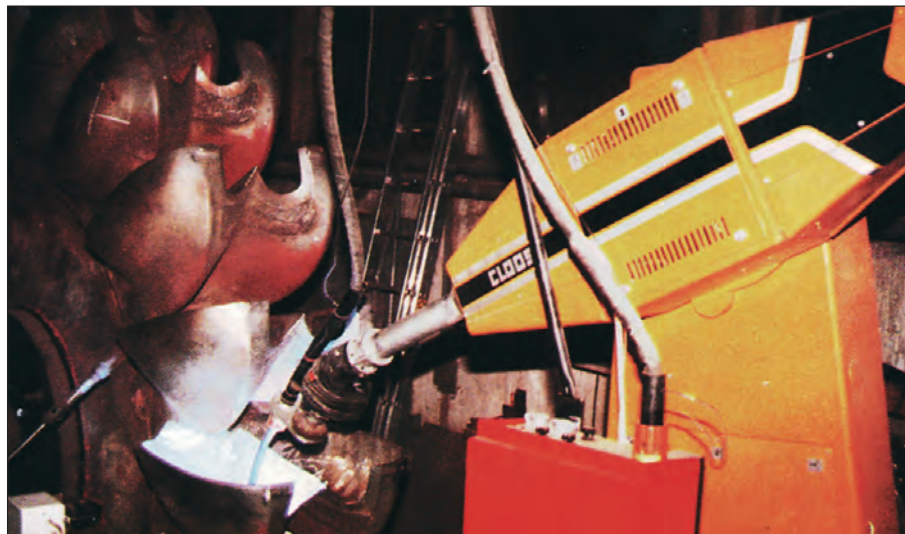
Bild 32: Einsatz eines Industrieroboters für das Schweißen einer Peltonturbinen-Laufrades aus GX5CrNi13-4 nach dem MSG-Verfahren
