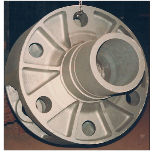
Planetenträger eines Antriebs für Zuckerrohrmühlen auf Mauritius aus G20MnMoNi5-5, Masse 3,8 t
