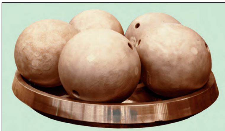
Mahlring (Dmr. 2860 mm, Masse 7,5 t) und Mahlkugeln (Dmr. 1000 mm, Stückmasse 2570 kg) für eine Kohlemühle aus G40CrNiMoV7-6
