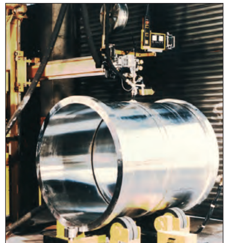
Bild 33: Zentrifugaltrommel aus zwei Schleudergusszylindern nach dem UP-Verfahren verschweißt; Werkstoff: GX5CrNiMoCuN26-6-3; Abmessungen Dmr. 1540 x 1750 mm
