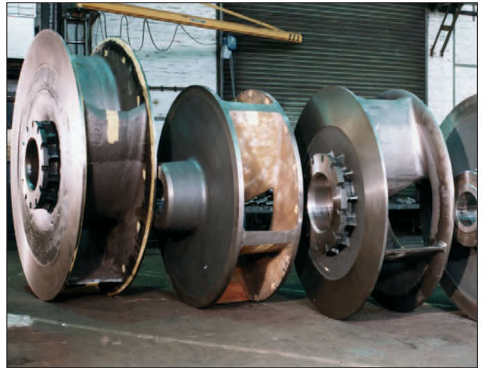
Laufräder aus hoch verschleißbeständigem Stahlguss für Nassbagger-pumpen mit bis 1750 mm Dmr.
