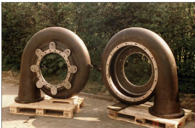
Bild 82: Gehäuse für Pumpen einer Rauchgas-Entschwefelungsanlage aus der Stahlgussorte GX3CrNiMoCuN26-6-3
