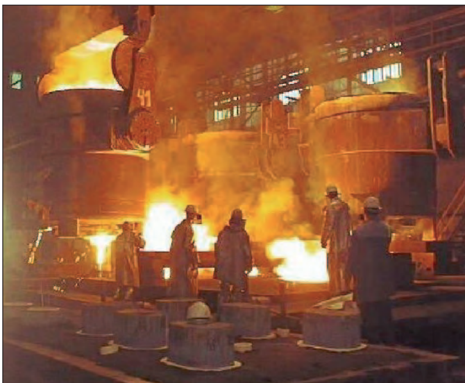
Bild 9: Abguss eines großen Stahlgussstücks mit mehreren Pfannen
