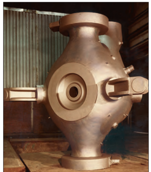
Ventilgehäuse für Dampfturbine aus G17CrMoV5-11, Masse 14,2 t
