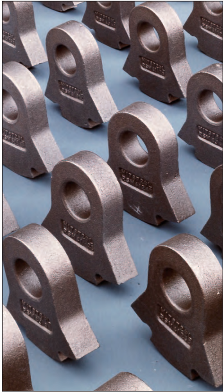
Bild 97: Shredderhämmer mit einer Stückmasse von 150 kg aus CrNiMo-legiertem Vergütungsstahlguss; die Augen wurden partiell auf höhere Zähigkeit angelassen
