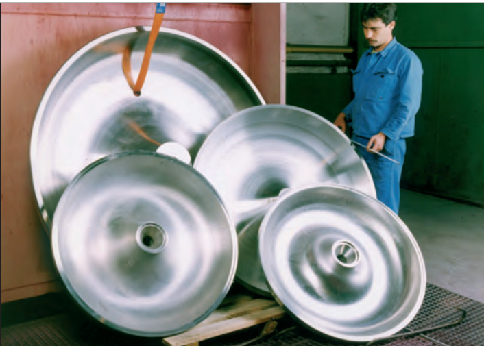
Kutterschüsseln für die Lebensmittelindustrie aus GX40CrNi27-4, Masse 200 bis 600 kg
