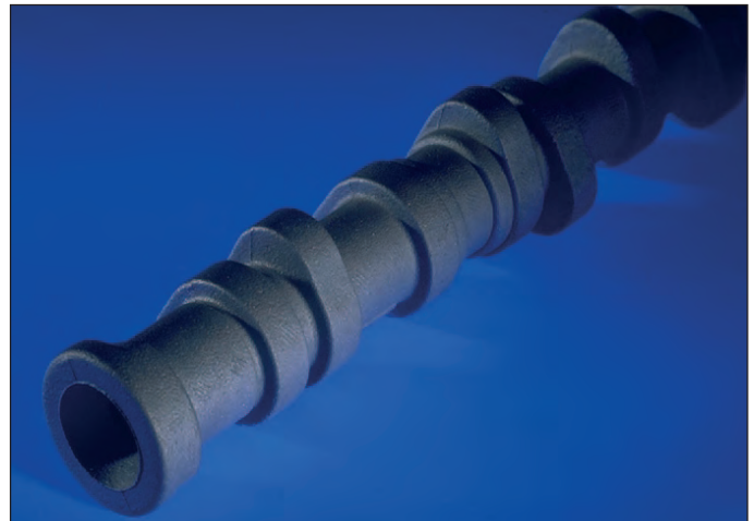
Bild 24: Nockenwelle für Ventiltrieb eines V6-PKW-Motors aus Stahlguss G100Cr6, Machbarkeitsstudie für eine hohlgegossene Nockenwelle mit stark reduzierter Bearbeitungszugabe (teilweise 6 mm), Gewicht 2,1 kg
