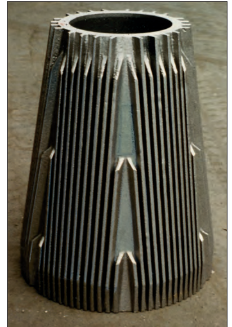
Mahlkörper für die Stoffaufbereitung in der Papierindustrie aus GX20CrMo13, Masse 65 kg, Abmessungen Dmr. 345 x 490 mm
