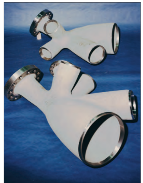
Bild 52: Einteilig gegossene Knoten für den Bau von Offshore-Ölbohrplattformen aus der Stahlsorte G13MnNi6-4; Masse 1250 bzw. 1050 kg
