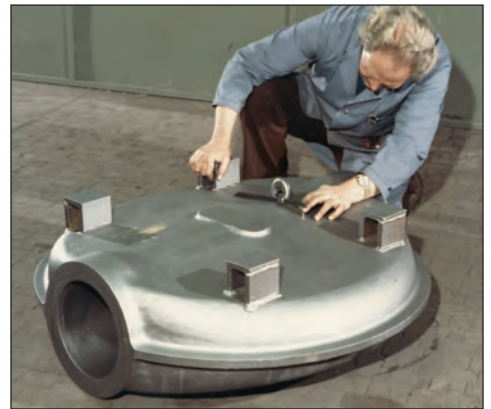
Absperrklappe für eine Dampfleitung aus warmfesten Vergütungsstahl der Abmessungen Dmr. 1080 x 340 mm, Masse 745 kg
