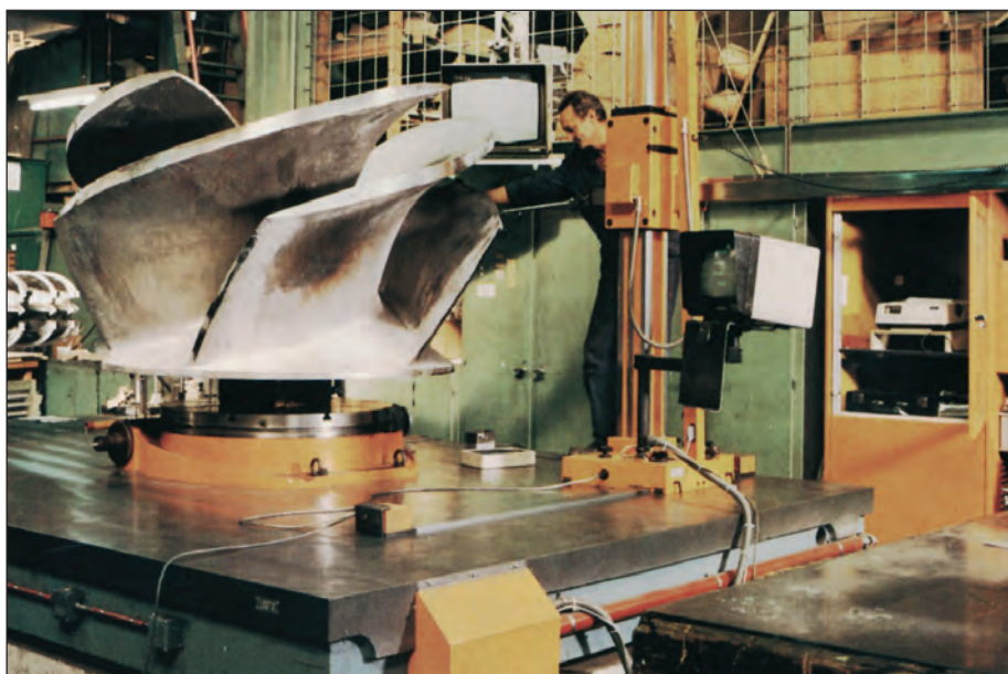
Bild 40: Pumpenlaufrad aus niedrig gekohltem CrNiMo-legiertem austenitischem Stahlguss bei der Maßkontrolle auf einer rechnergestützten 3D-Messmaschine (Gussteilabmessungen Dmr. 1930 x 1300 mm, Masse 4,3 t)
