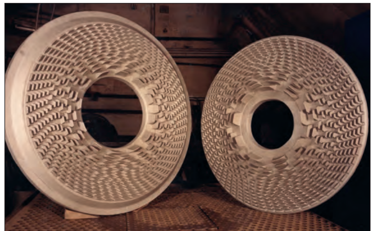
Bild 96: Mahlplatten (Dmr. 1000 mm) aus hochverschleißfestem Stahlguss, deren Zahnpartien mit hoher Teilungsgenauigkeit und Oberflächengüte bearbeitungsfrei vorgegossen sind
