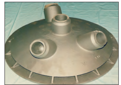
Stahlbaukonstruktion am Tagungszentrum Hannover mit gegossenen Knotenteilen (Teilbilder rechts) aus G20Mn5, normalisiert Kapitell-Aufsatz mit Pylonanschluss aus G20Mn5 N, Dmr. 1,78 m, Masse 4 t (rechts oben) Kapitell-Aufsatz aus G20Mn5 N, Dmr. 1,54 m, Masse 2,05 t (rechts unten)
