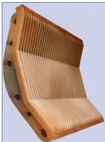
Prallschwinge für einen Brecher aus GX120Mn12, Masse 18 t, Abmessungen 3,3 x 2,8 x 0,94 m
