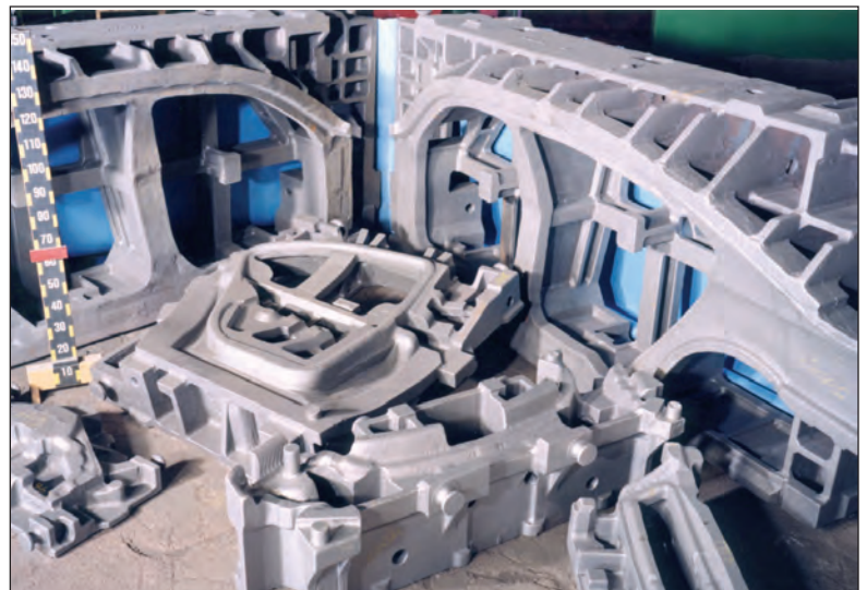
Blechumformwerkzeuggussteile aus verschiedenen hoch verschleißbeständigen Stahlgussorten für den Automobilbau im Massebereich von 100 bis 5000 kg
