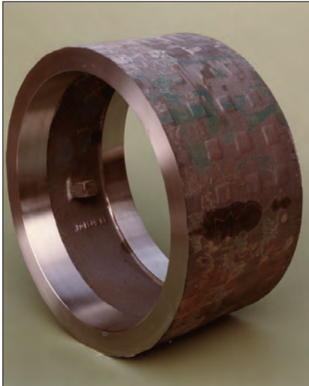
Bild 99: Walzenmantel für eine Mühle aus GX165CrMoV12 der Abmessungen Dmr. 1000 x 500 mm; Masse 900 kg
