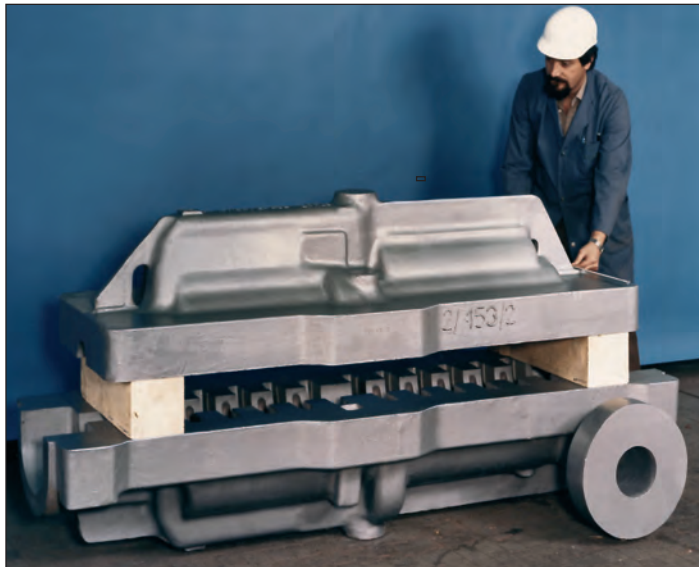
Bild 87: Mehrstufen-Pumpengehäuse aus GX2NiCrMoCuN25-20 der Abmessungen 1800 x 700 x 500 mm; Masse gesamt 3220 kg
