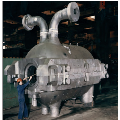
HD-Außengehäuse für eine Dampfturbine aus G17CrMoV5-11, Masse 85 t
